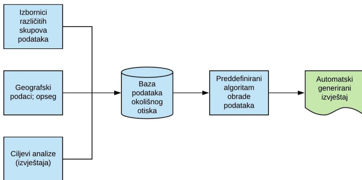
**Slika 13: Shematski prikaz osnova informatičkog rješenja za izradu automatski generiranih izvještaja**
