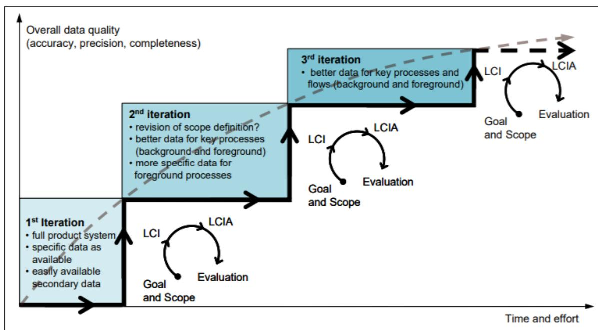
Slika 6: Shematski prikaz iterativne „prirode“ LCA analize<sup>4</sup>
