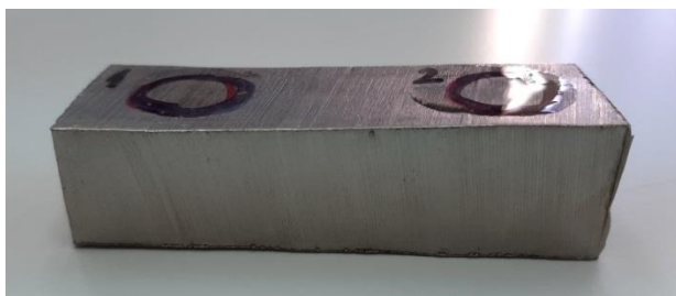
Uzorak 3: uzorak s neparalelnim površinama
