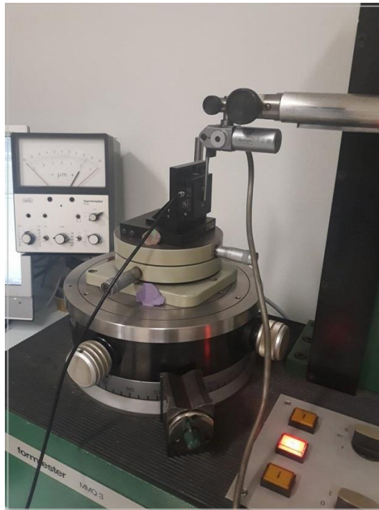
Slika 40 Postavljanje piezo aktuatora na MMQ-3 uređaj [2]
