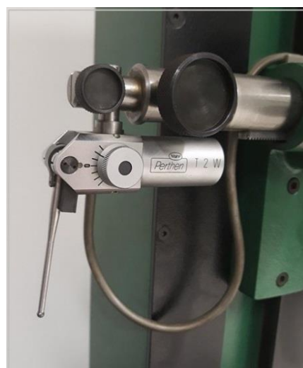
Slika 7 Induktivno ticalo uređaja za mjerenje kružnosti [2]
