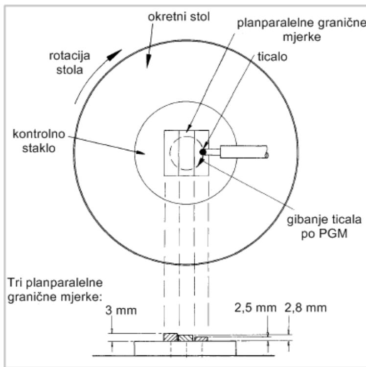
Slika 20 Umjeravanje pomoću planparalelnih graničnih mjerki [4]
