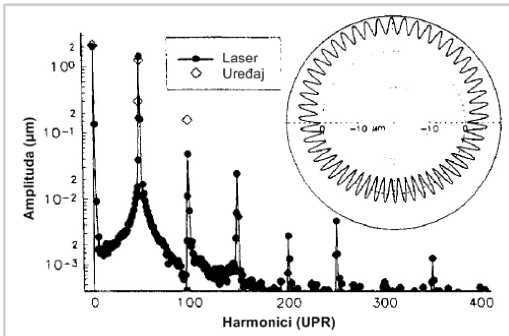
Slika 29 Amplitudni spektar izmjerenoj signala [17]
