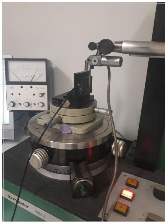
Slika 40 Postavljanje piezo aktuatora na MMQ-3 uređaj [2]
