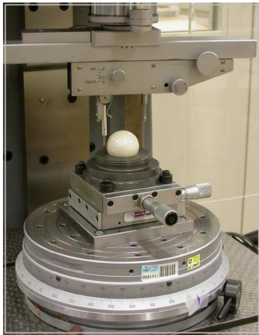
Slika 17 Ispitivanje mjerne kugle [12]
