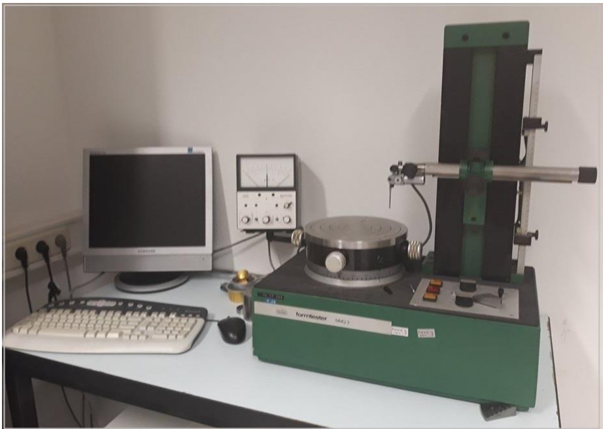
Slika 10 Mjerni sustav za ispitivanje kružnosti [2]
