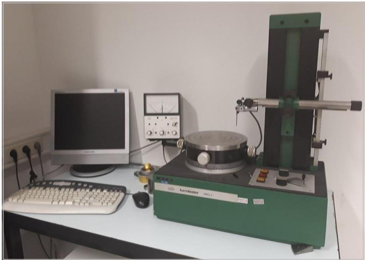
Slika 10 Mjerni sustav za ispitivanje kružnosti [2]
