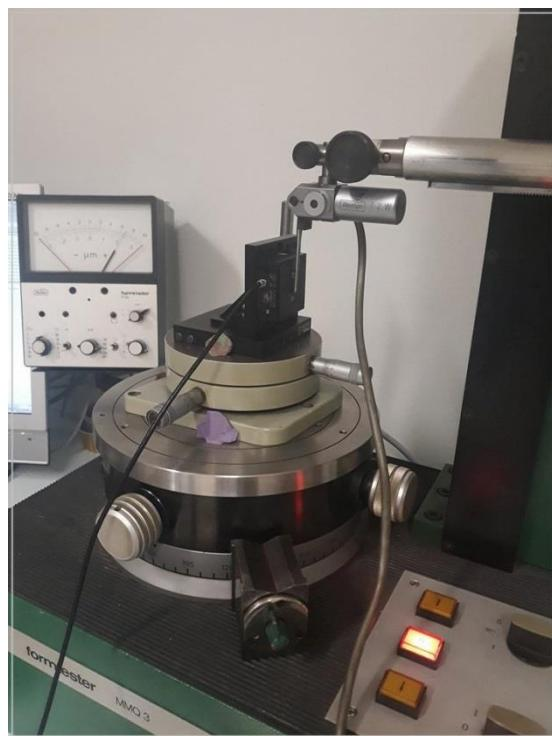
Slika 40 Postavljanje piezo aktuatora na MMQ-3 uređaj [2]
