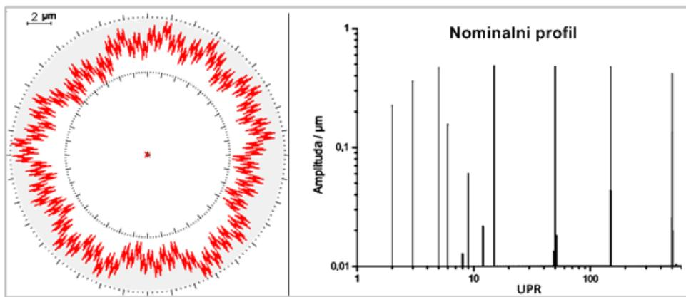
Slika 37 MWS-8 i amplitudni spektar nominalnog profila [10]
