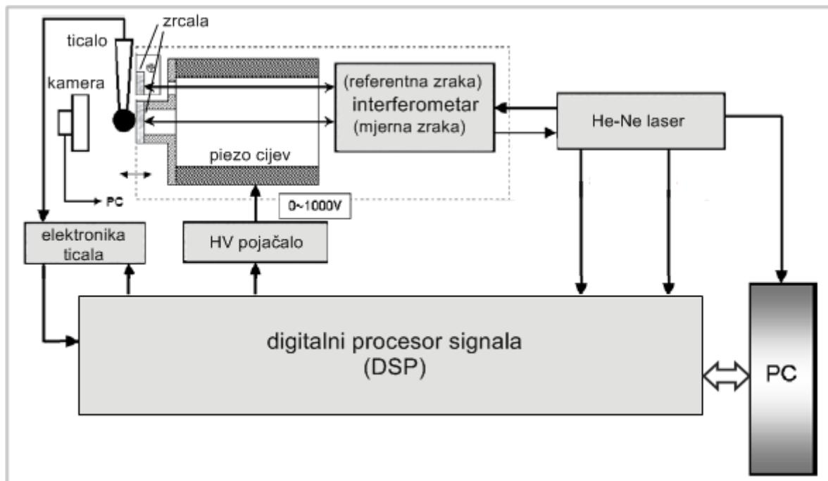
Slika 30 Sustav za umjeravanje ticala pomoću piezo aktuatora [18]
