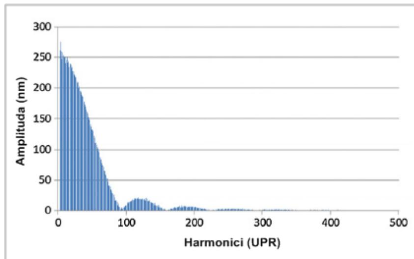
Slika 35 Amplitudni spektar umjeravanog Flick etalona [20]
