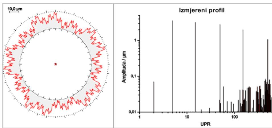
Slika 36 MWS-1 i amplitudni spektar izmјerenog profila [10]
