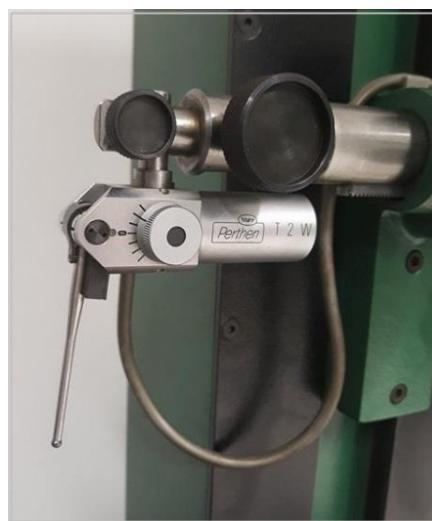
Slika 7 Induktivno ticalo uredaja za mjerjenje kružnosti [2]
