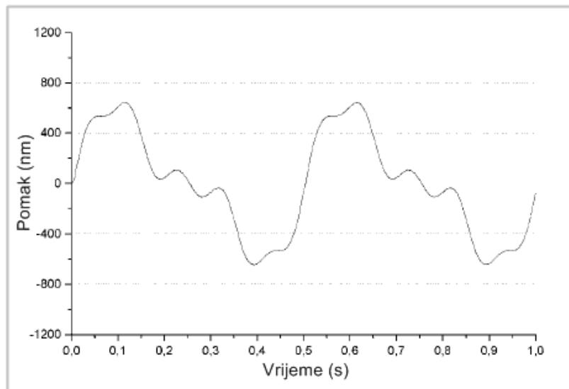
Slika 31 Simulirani Multi-wave etalon [18]
