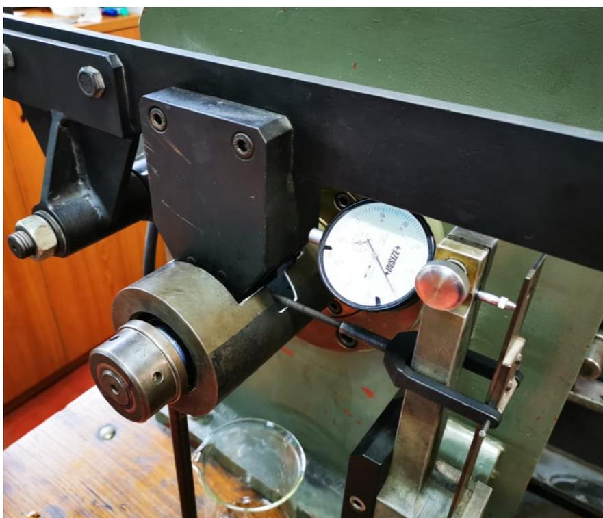
Slika 31. Ispitivanje adhezijskog trošenja u vlažnom stanju
