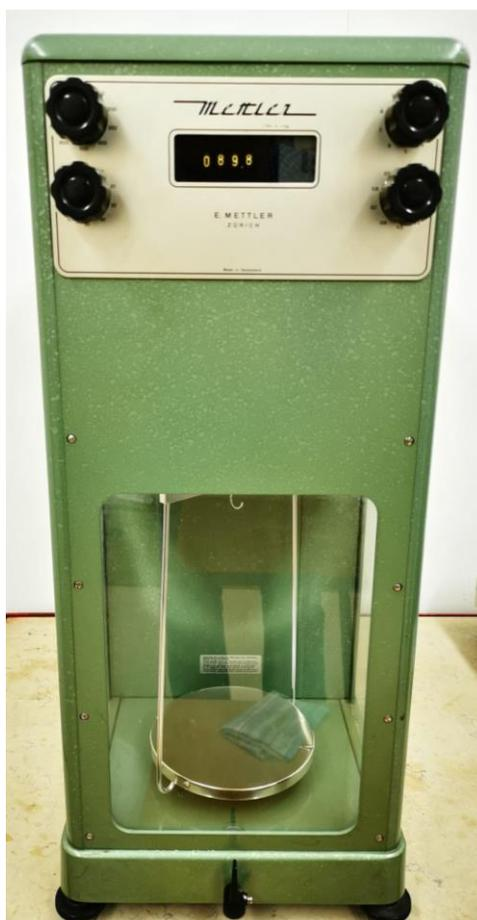
**Slika 26. Laboratorijska vaga E. Mettler**
