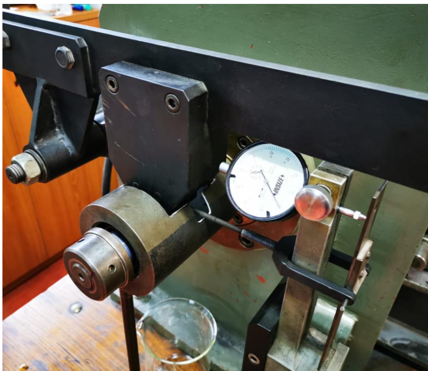
Slika 31. Ispitivanje adhezijskog trošenja u vlažnom stanju
