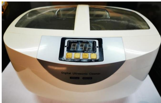
**Slika 25. Digitalna ultrazvučna čistilica YM-4820 2.5 l**
