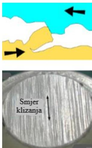
Slika 6. Abrazijsko trošenje poliamida [11]
