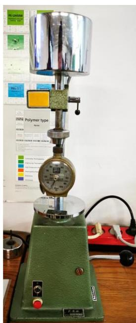
Slika 34. Uređaj za ispitivanje tvrdoće po Shore D
