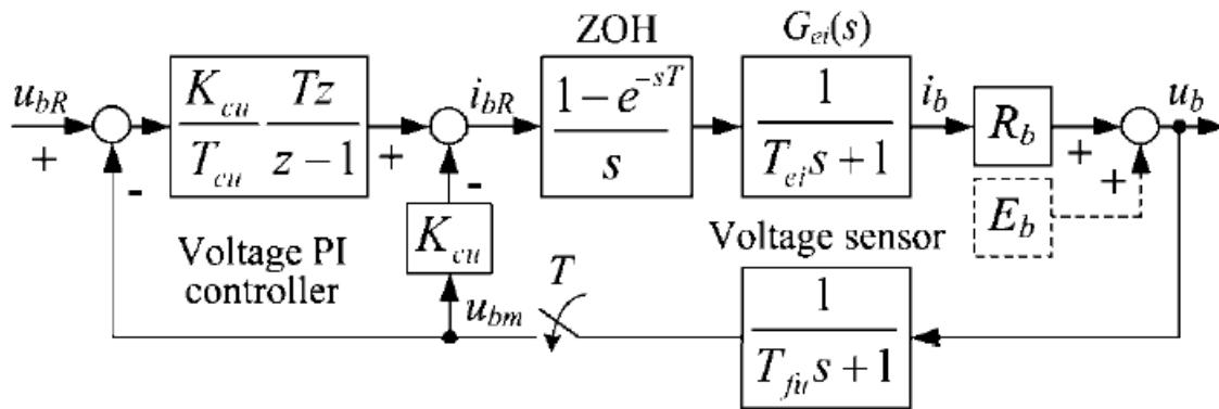
Slika 18. Ekvivalentni blok dijagram regulacijskog kruga napona [3.]
