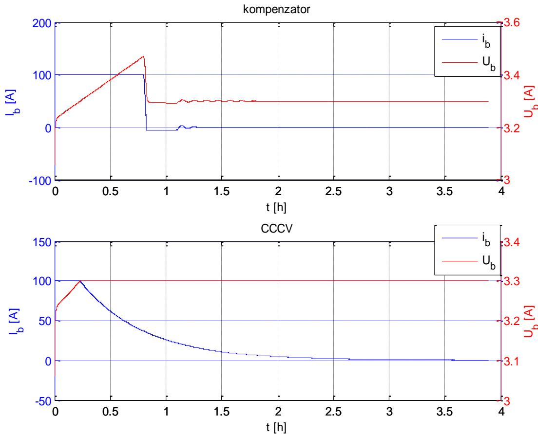
Slika 29. Usporedba strujno-naponske karakteristike kompenzatora i CCCV-a
