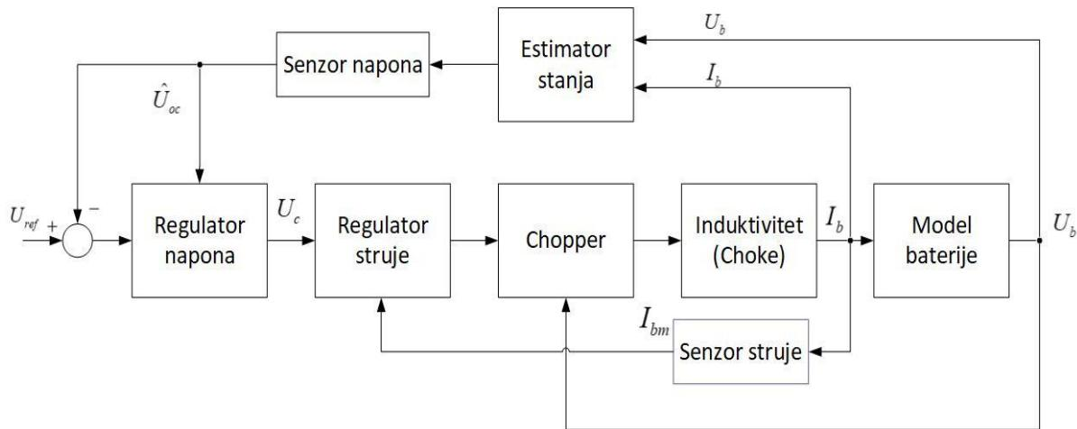
Slika 22. Modificirana regulacija po naponu otvorenog kruga
