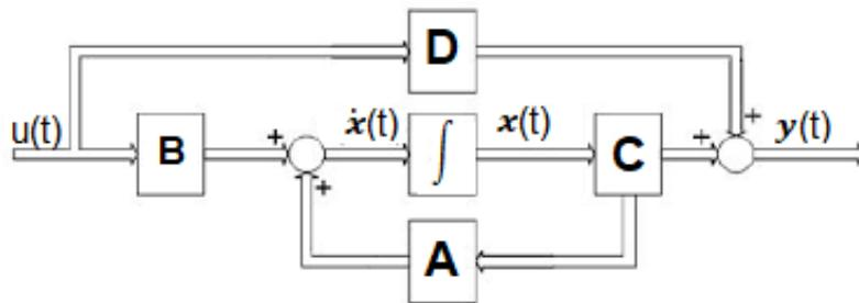
Slika 10. Blok dijagram linearnog vremenski invarijantnog sustava [2.]
