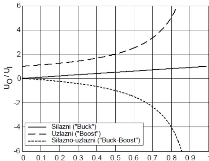
Slika 16. Prijenosne karakteristike DC-DC pretvarača [5.]
