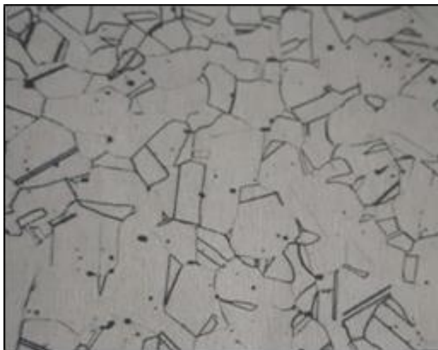
Slika 6. Mikrostruktura austenitnog čelika [7]
