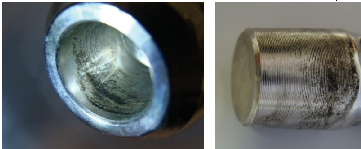
Slika 22. Korozijsko oštećenje modularne endoproteze zgloba kuka na spoju glava / vrat [28]
