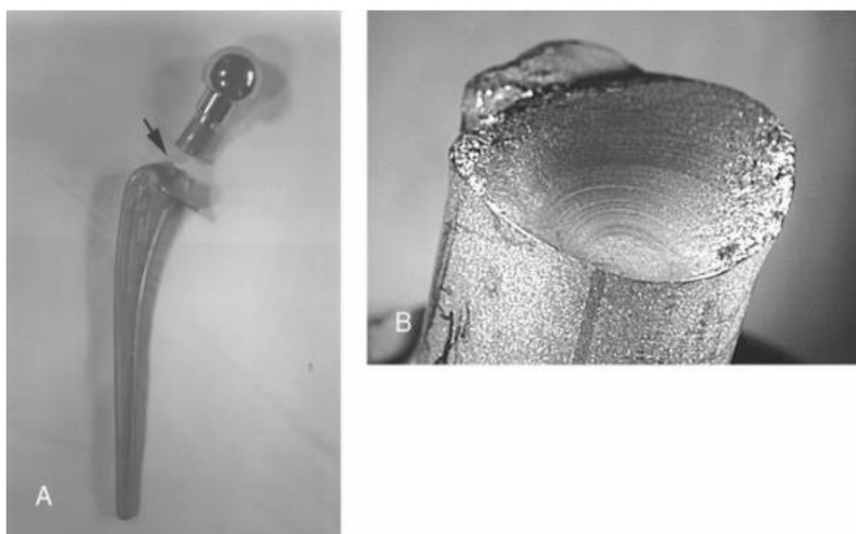
Slika 21. Lom zbog umora materijala [16]
