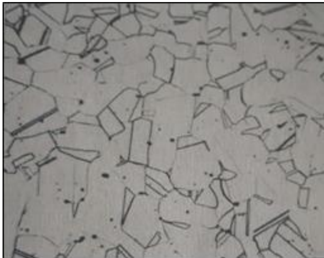
Slika 6. Mikrostruktura austenitnog čelika [7]
