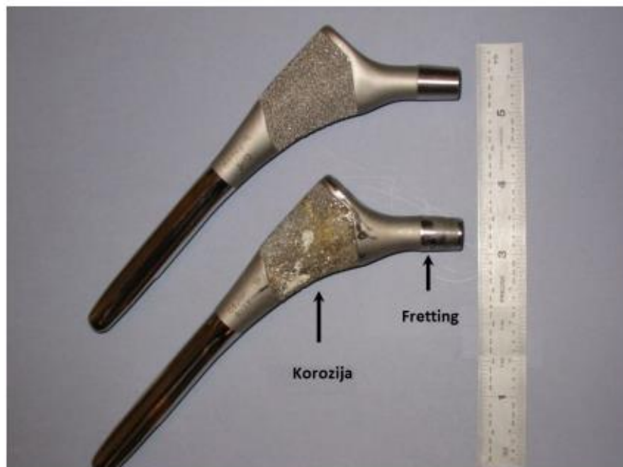
Slika 18. Korozivska oštećenja na femoralnom dijelu [9]
