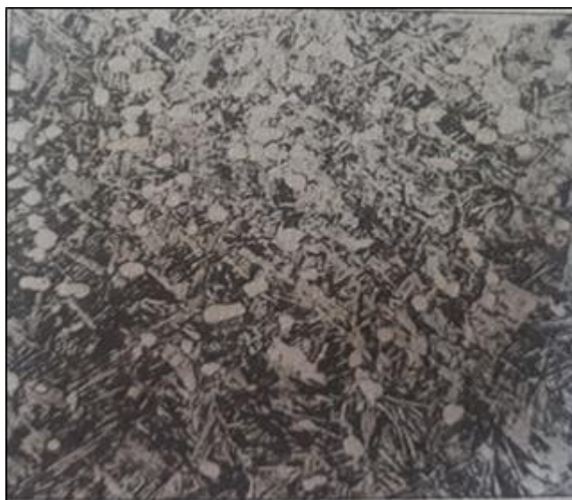
Slika 3. Mikrostruktura legure Ti - 6 Al – 4V [7]
