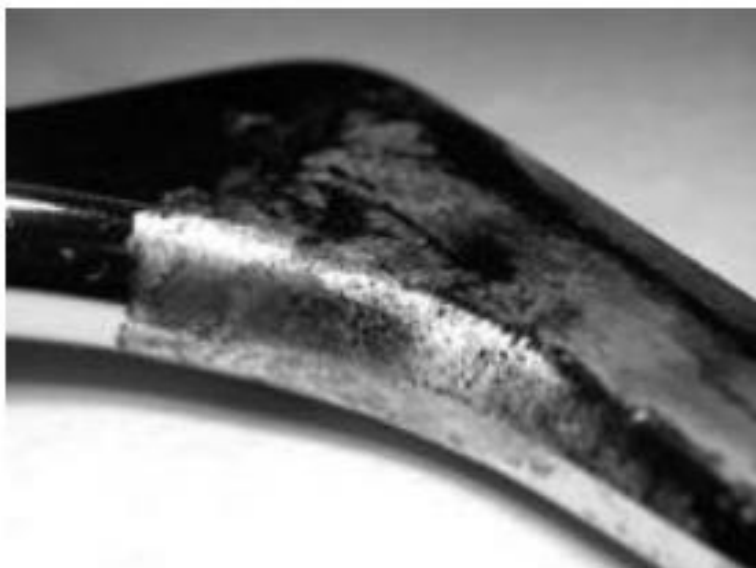
Slika 19. Korozivsko oštećenje implantata od nehrđajućeg čelika [16]
