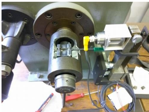
Slika 33. Metoda "Block on ring" s posudom za ispitivanje u vlažnom stanju
