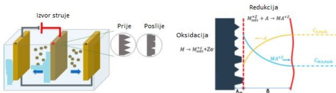
Slika 20. Shematski prikaz procesa elektropoliranja [19]
