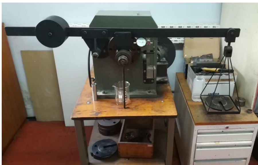
Slika 32. Ispitivanje adhezijskog trošenja "Block on ring" metodom
