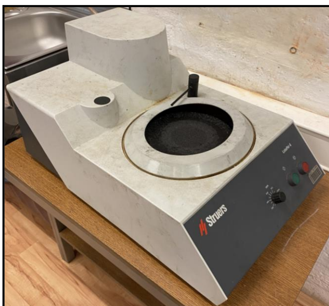
Slika 33. Uredaj za grubo brušenje „Struers LaboPol6“
