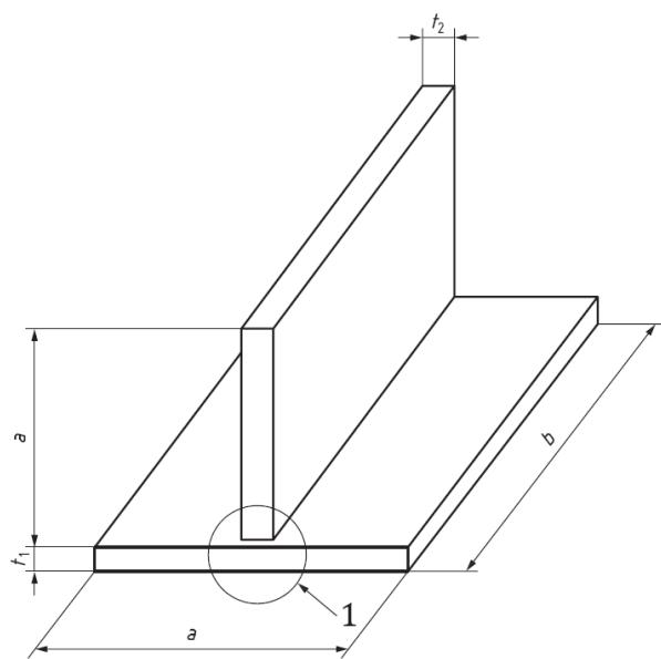
1 – priprema spoja izvedena prema pWPS-u
