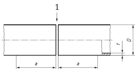
1 – priprema spoja izvedena prema pWPS-u
