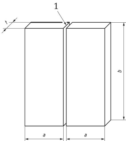
1 – priprema spoja izvedena prema pWPS-u
