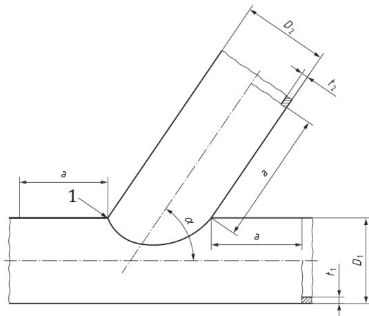
1 – priprema spoja izvedena prema pWPS-u
