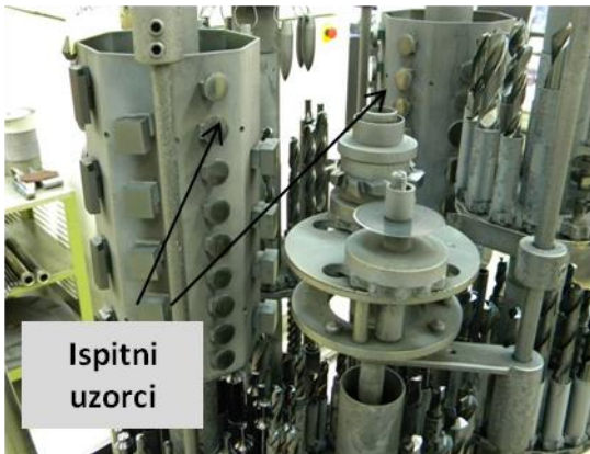
Slika 6.9: Smještaj uzoraka tijekom prevlačenja PVD postupkom
