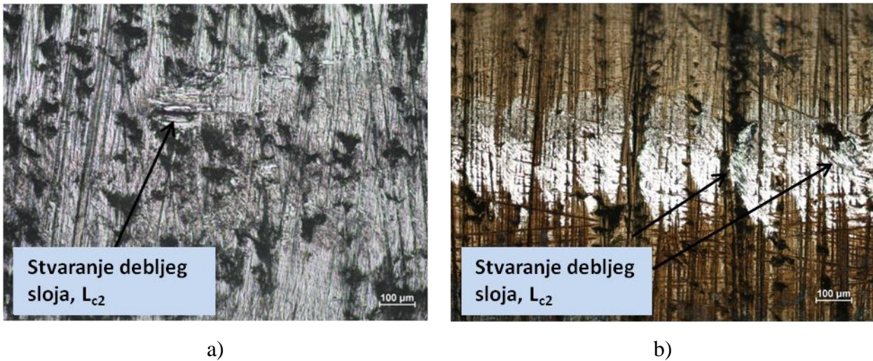
Slika 6.42: Stvaranje debljeg sloja, L_{c2} : a) uzorak P0, b) uzorak P1
