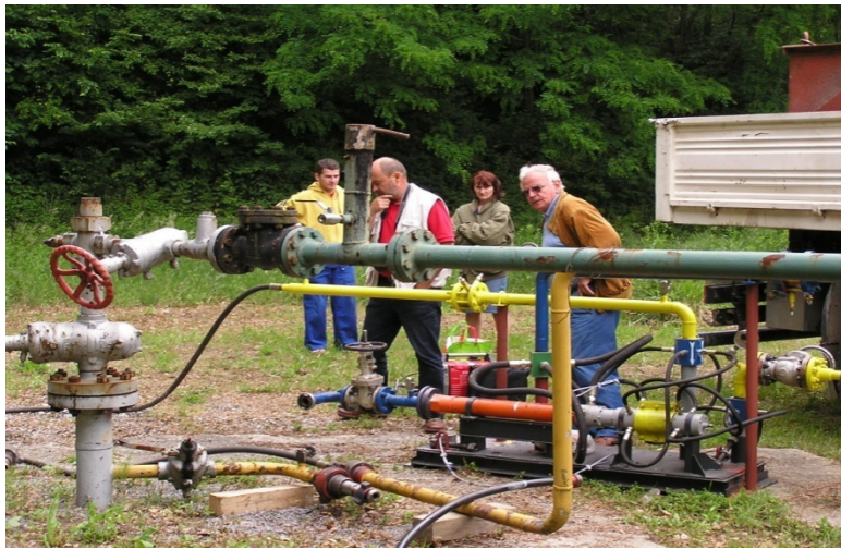
Slika 15 Ispitivanje na površini zemlje s metanom kao radnim fluidom na naftnom polju Šandrovac
