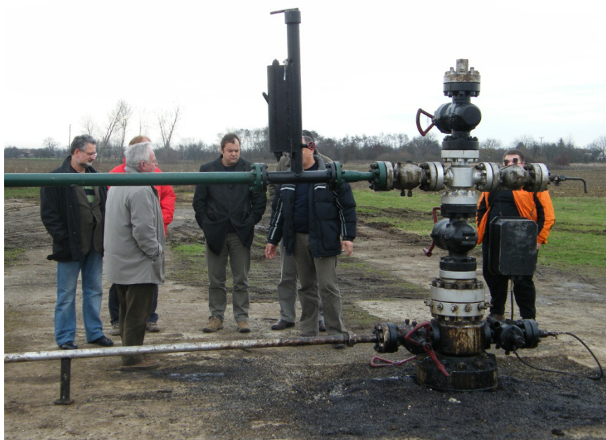
Slika 16 Ispitivanja turbinskog plinskog dizala u uvjetima bušotine na naftnom polju Beniĉanci
