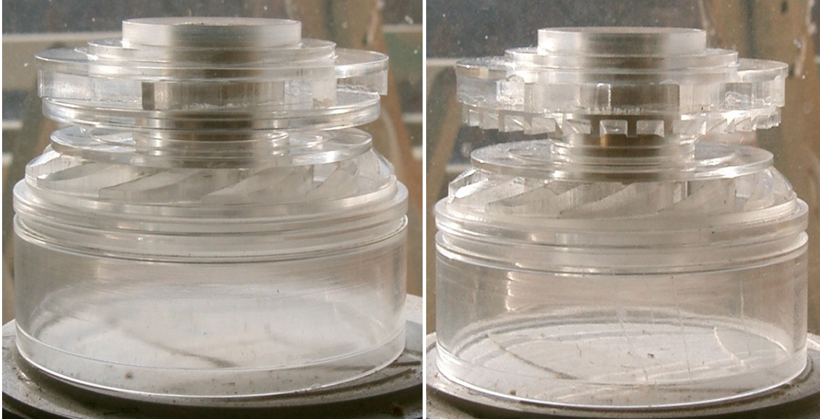
Slika 24 Centrifugalni i centrifugalno vrtložni stupanj 2VNN5-79 izrađeni od pleksi stakla za potrebe eksperimentalna istraživanja
