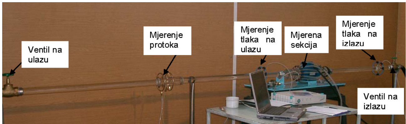
Slika 25 Eksperimentalna linija za ispitivanja CV i V pumpe
