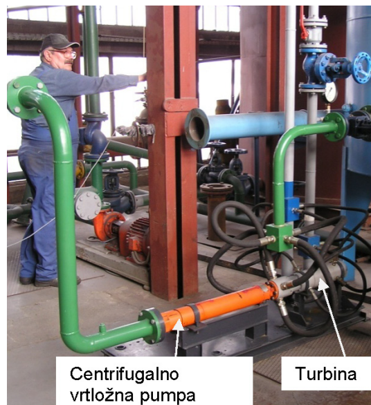
Slika 14 Ispitivanje plinsko turbinskog dizala sa zrakom kao radnim fluidom u Laboratoriju za hidromehaniku i hidrauličke strojeve
