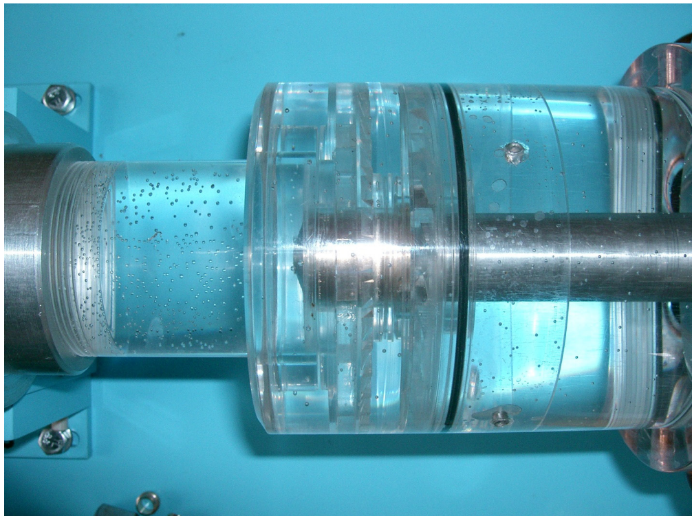
Slika 27 Kućište s ugrađenim stupnjem koji se ispituje
