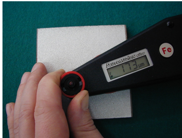
Slika 3.16 Mjerenje debljine sloja.
