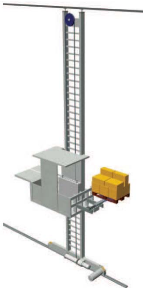
Slika 29. S/R dizalica person-on-board (Viasprint)
