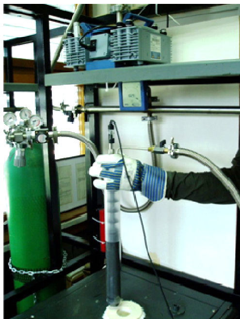
Slika 51 Induciranje početka kristalizacije u fiksnoj točki kositra vađenjem cijelog sklopa iz peći
