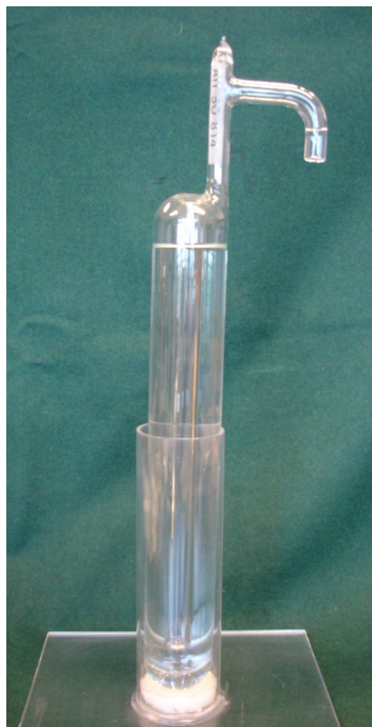
Slika 30 Trojna točka vode Isotech model E11
