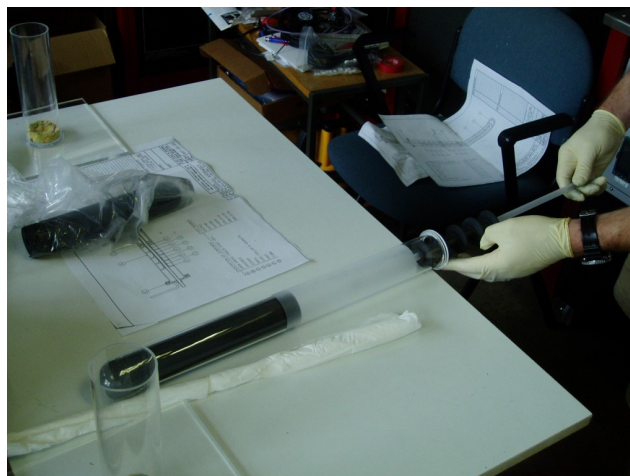
c) Ulaganje kvarcne cijevi u grafitnu kokilu
