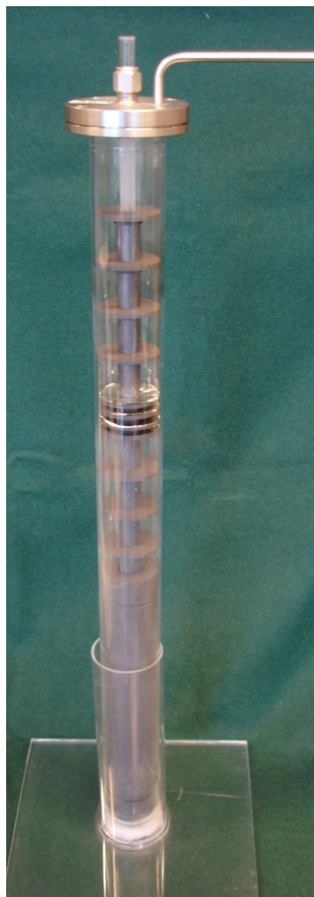
Slika 32 Fotografija otvorenog tip fiksne točke koji se koristi u LPM-u
