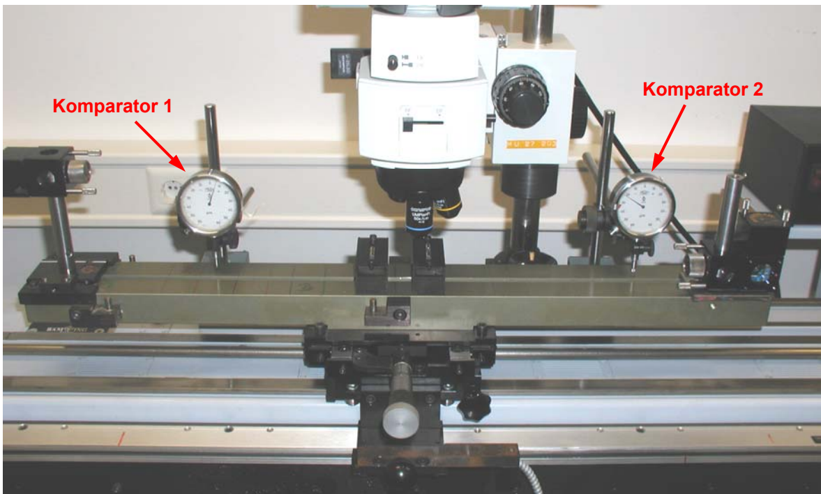
Slika 94. Mjerenja zakreta stola provedeno s dva komparatora
