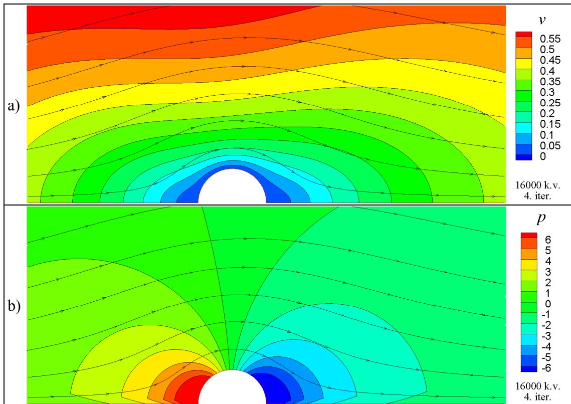
*Slika 5.30 Primjer 6 Detalj rješenja dobivenog primjenom FLOP algoritma na mreži M2 (16000 k.v.):
