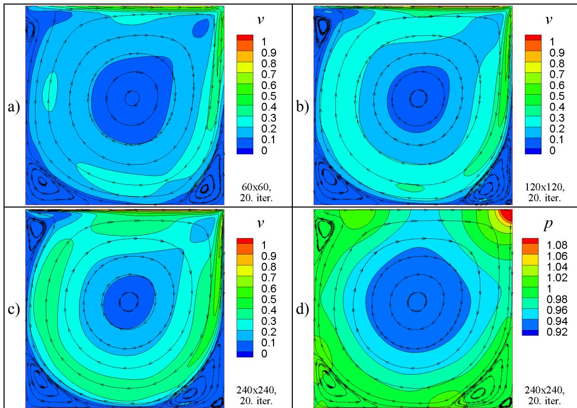
*Slika 5.20 Primjer 5. Rješenje prema FLOP algoritmu dano strujnicama i poljima absolutne vrijednosti brzine i tlaka: a), b) i c) polje brzine na mrežama M1, M2 i M3; d) polje tlaka na mreži M3*
