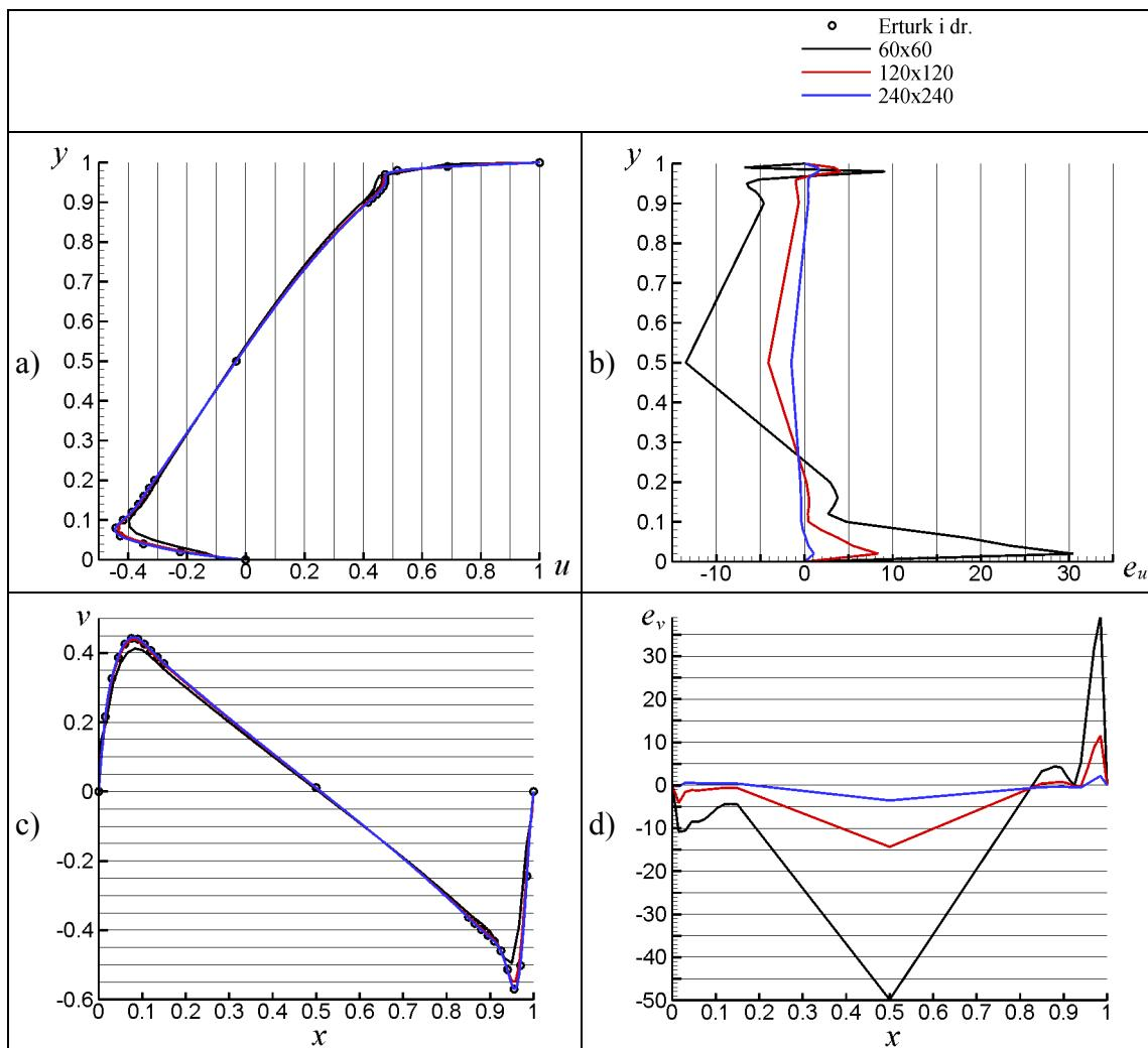
Slika 5.27 Primjer 5. Usporedbi profila brzine dobivenih FLOP algoritmom uz primjenu EDSI sheme diferencije s rješenjem drugih autora [17] i relativna odstupanja u postotcima:
