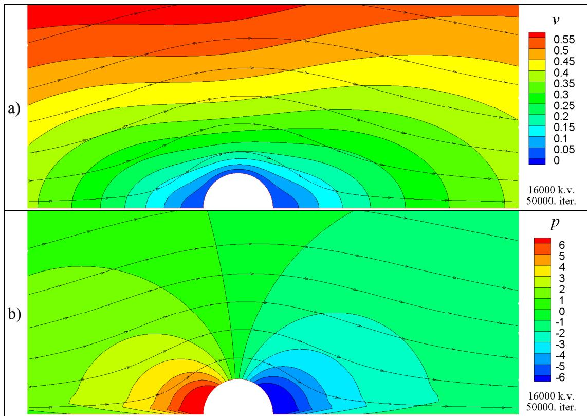
Slika 5.31 Primjer 6 Detalj rješenja dobivenog primjenom SIMPLE algoritma na mreži M2 (16000 k.v.):
