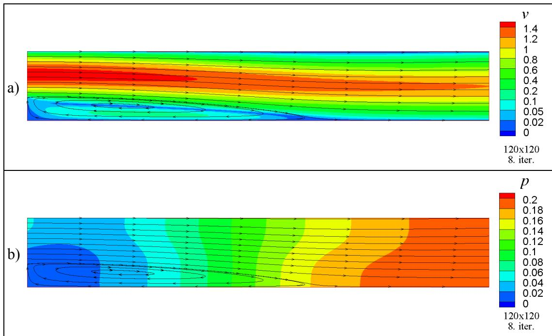
*Slika 5.35 Primjer 7. Rješenje dobiveno primjenom FLOP algoritma na mreži M2 (120x120 k.v.):
