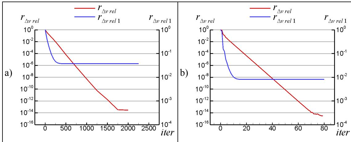
Slika 5.40 Primjer 8. Konvergencija rješenja prema srednjim relativnim razlikama brzine  $r_{\Delta v \text{ rel} 1}$  i vlastitim  $r_{\Delta v \text{ rel}}$ :
