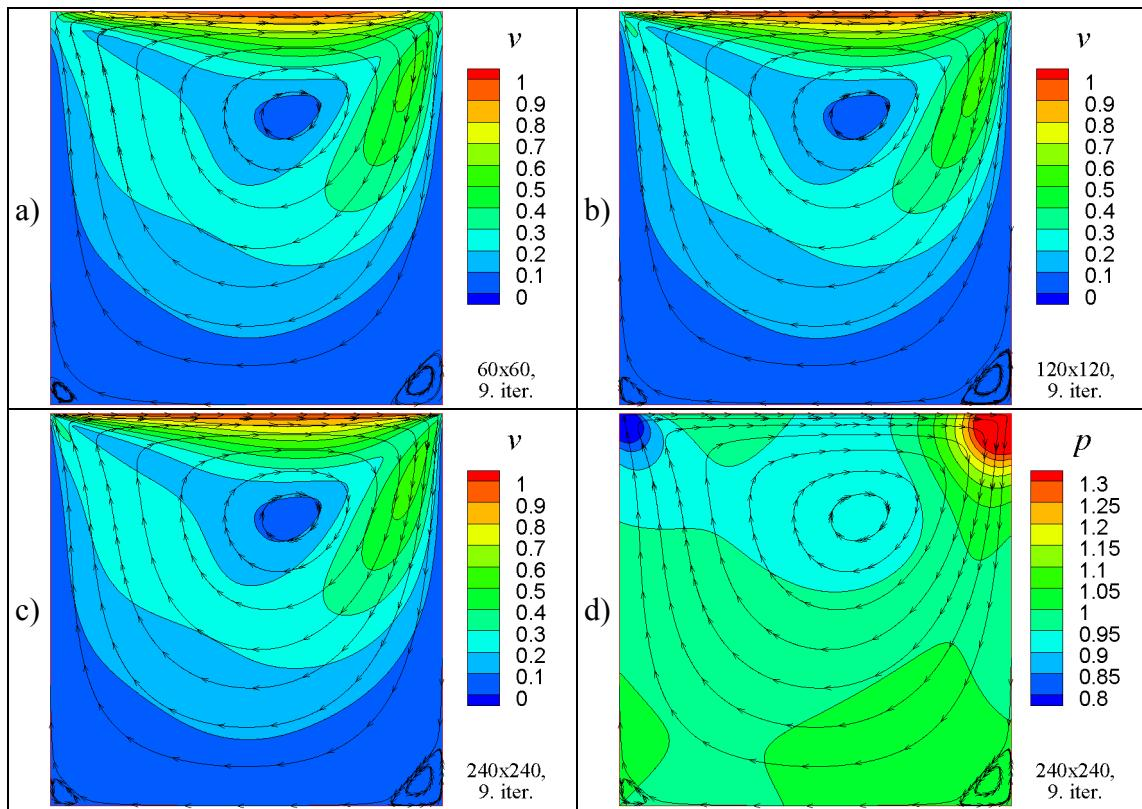
*Slika 5.16 Primjer 4. Rješenje prema FLOP algoritmu dano strujnicama i poljima absolutne vrijednosti brzine i tlaka: a), b) i c) polje brzine na mrežama M1, M2 i M3; d) polje tlaka na mreži M3*
