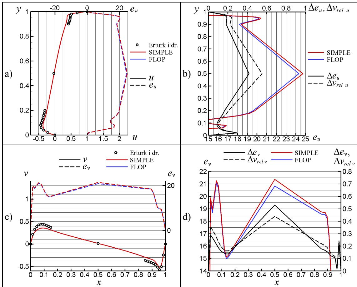
*Slika 5.24 Primjer 5. Usporedbi profila brzine dobivenih FLOP i SIMPLE algoritmima uz primjenu EDS sheme na mreži M3 s rješenjem drugih autora [17] i relativna odstupanja u postotcima:*
