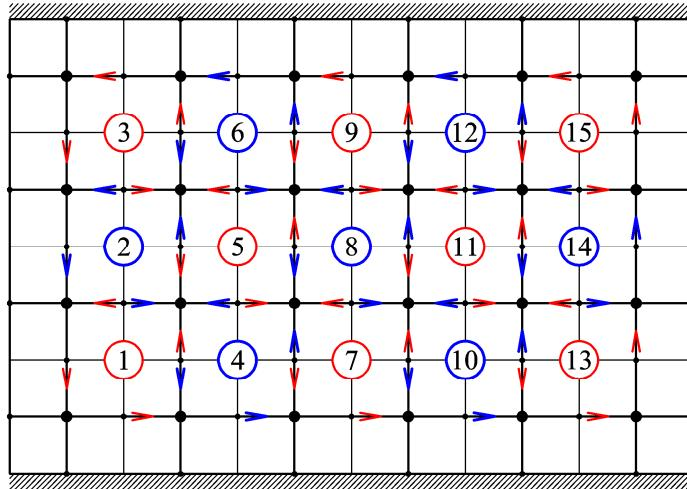
Slika 4.4 Formiranje elementarnih petlji u globalnom kontrolnom volumenu
