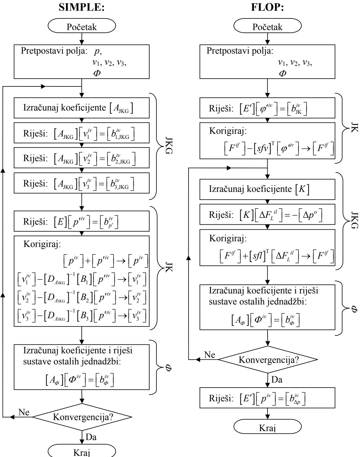
Slika 4.7 Usporedni prikaz algoritama SIMPLE i FLOP
