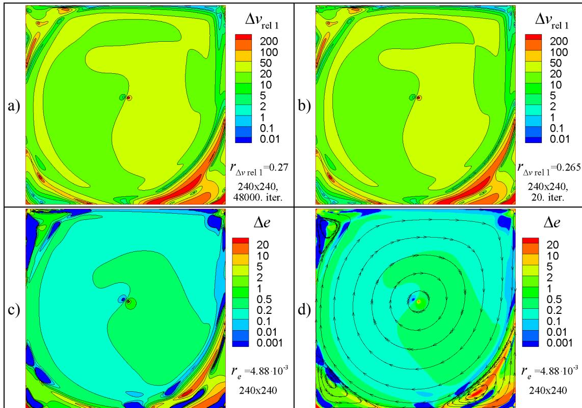
Slika 5.25 Primjer 5. Prikaz relativne razlike polja brzine za slučaj odabira referentnog polja proizašlog primjenom FLOP algoritma i EDSI sheme diferencije:
