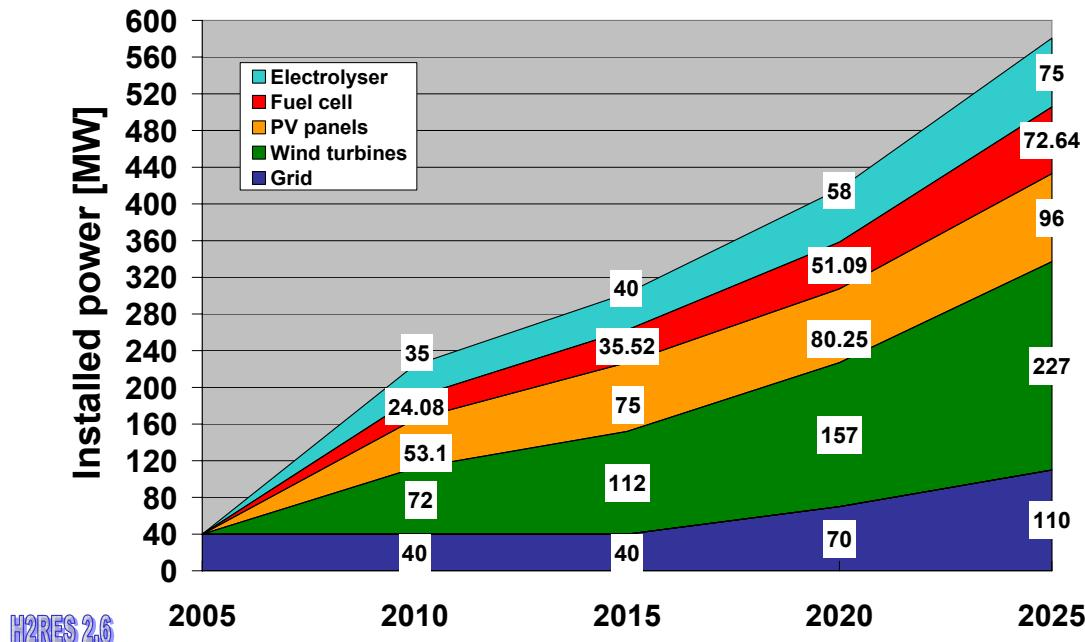
Slika 58. Snaga instaliranih komponenti po godinama za scenarij H<sub>2</sub>VjetarSunce100% + PTV
