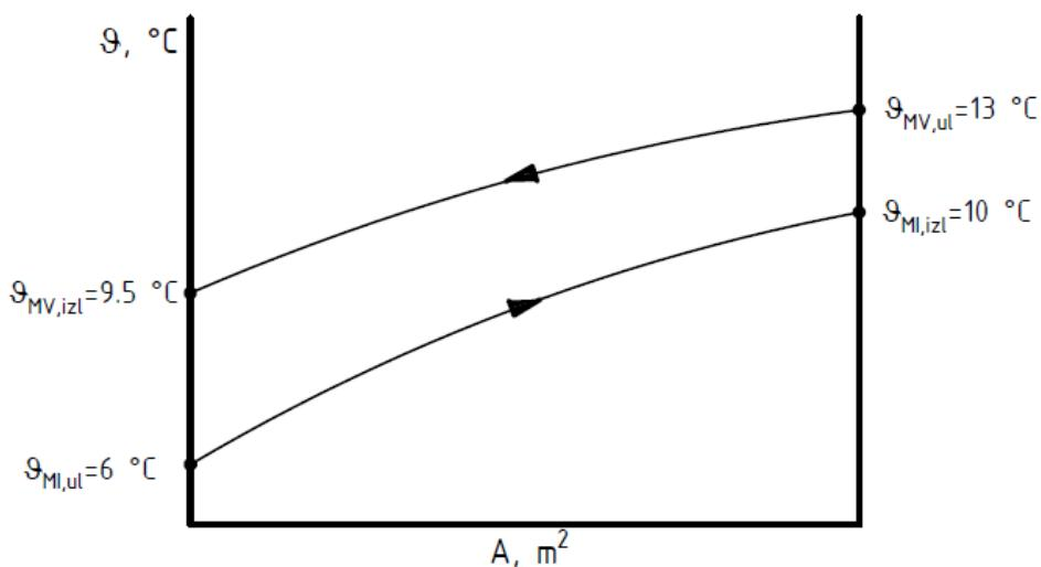
Slika 27.  $\vartheta - A$  dijagram izmjene topline u međuizmjerenjivaču
