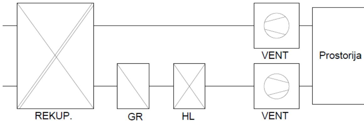
Slika 8. Pojednostavljena shema sustava ventilacije i klimatizacije [10]
