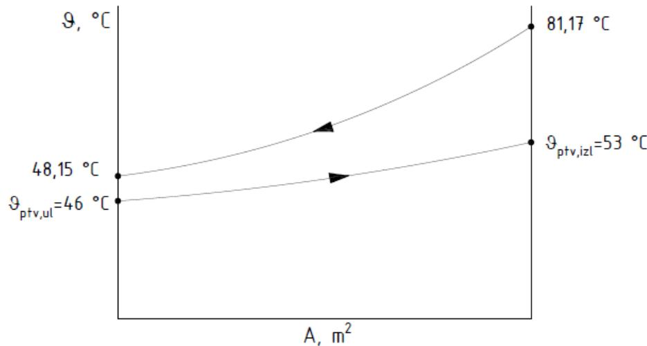
Slika 29.  $\vartheta - A$  dijagram izmjene topline u izmjenjivaču PTV-a
