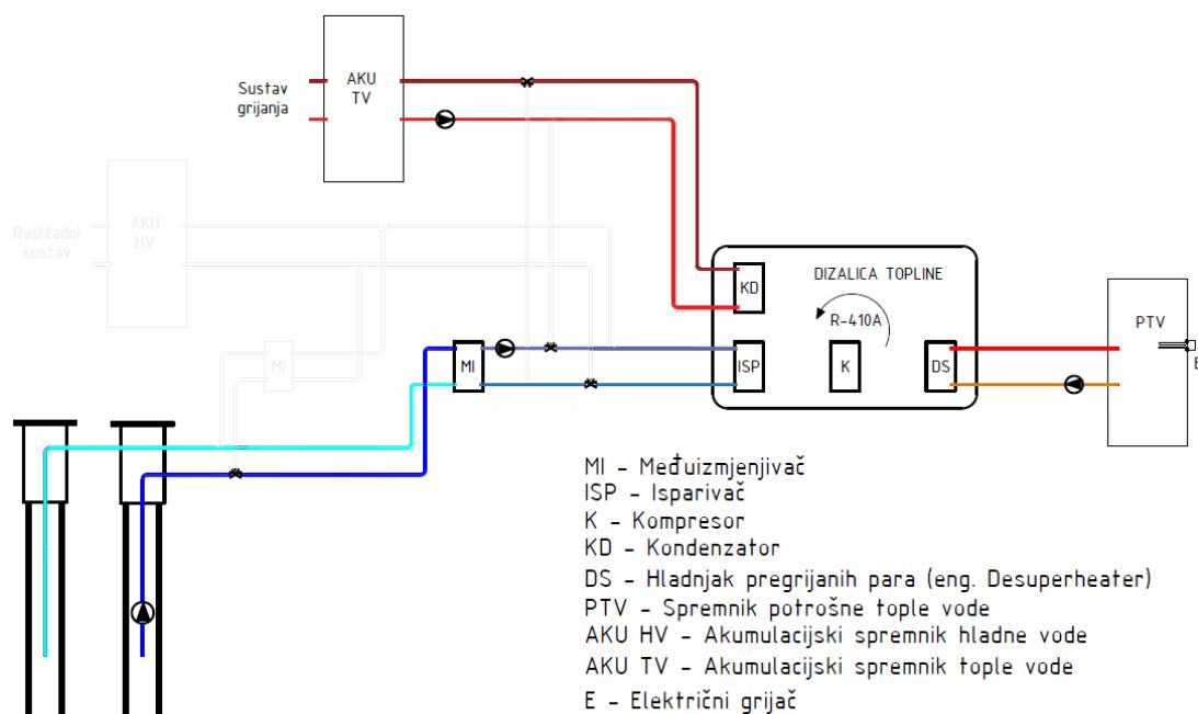
Slika 14. Pojednostavljena shema sustava dizalice topline – režim grijanja
