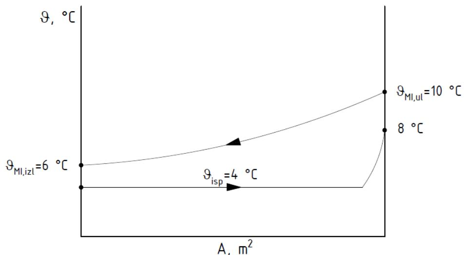
Slika 25.  $\vartheta - A$  dijagram izmjene topline u isparivaču
