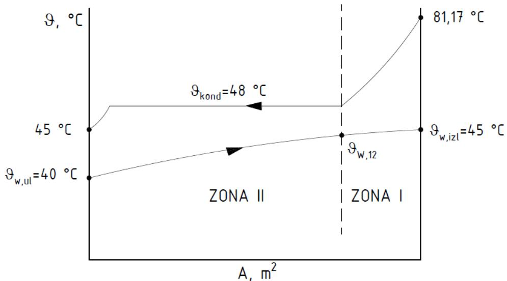
Slika 22.  $\vartheta - A$  dijagram izmjene topline u kondenzatoru
