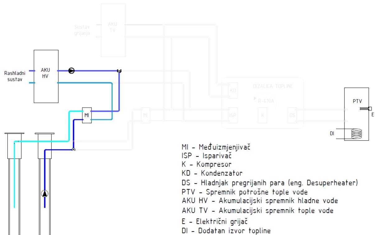
Slika 17. Pojednostavljena shema sustava dizalice topline – pasivno hlađenje
