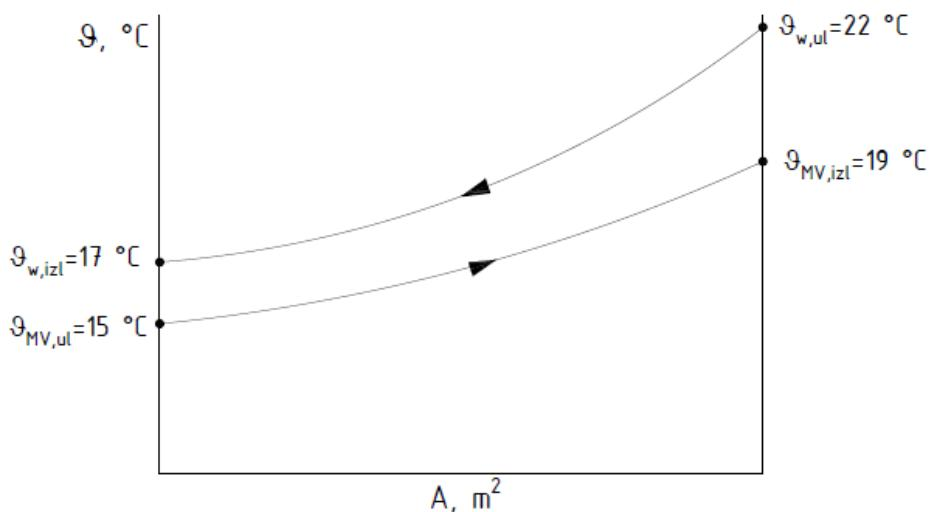
**Slika 35.  $\vartheta - A$  dijagram izmjene topline u dodatnom međuizmjjenjivaču**
