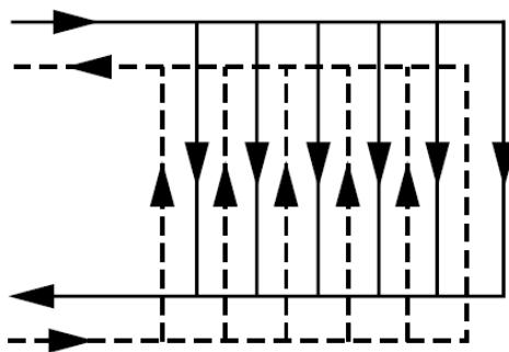
Slika 20. Raspored strujanja fluida unutar izmjenjivača [17]
