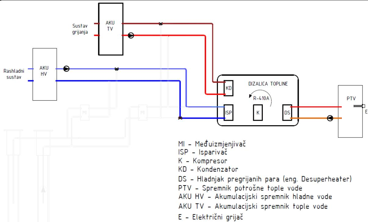
Slika 16. Pojednostavljena shema sustava dizalice topline – prijelazna razdoblja
