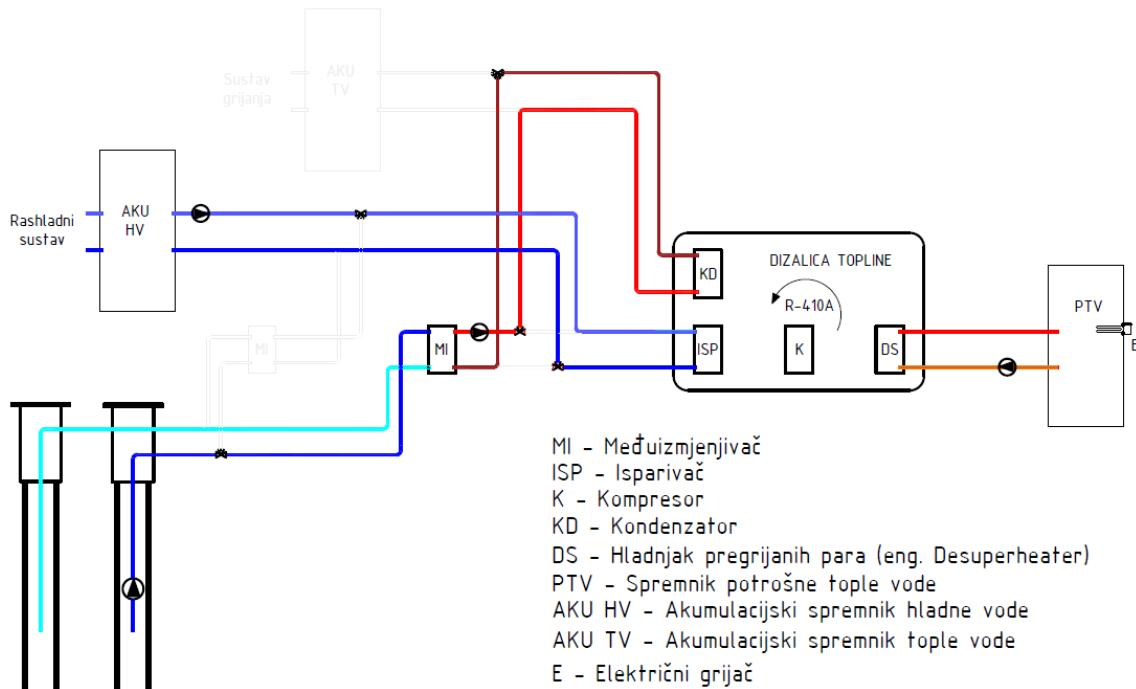
Slika 15. Pojednostavljena shema sustava dizalice topline – režim hlađenja
