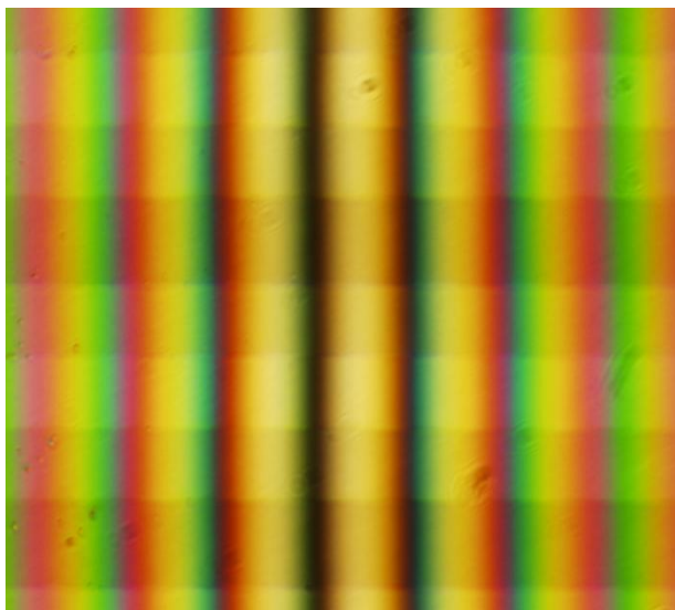
Slika 6.18 Etalon nazivne dubine brazde 50 nm. Interferogram primarne strukture Si/SiO 2
