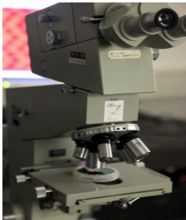
Slika 5.1 Interferencijski mikroskop Epival-Interphako
