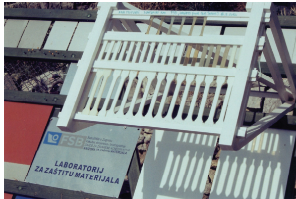
Slika 6.13. Terenska ispitivanja utjecaja atmosferilija
