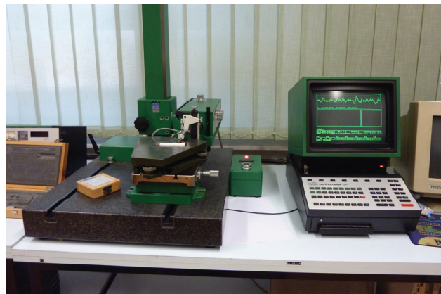
Slika 6.14. Uređaj za ispitivanje hrapavosti površine
