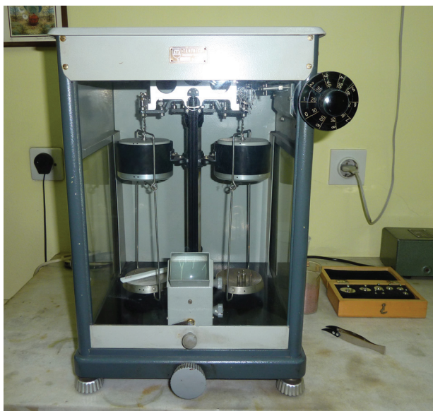
Slika 6.11. Vaga za mjerenje mase proizvođača Tehtnica – Železniki , Slovenija
