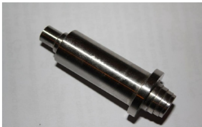
Slika 10: „Bravice“ rađene na CNC obradnom centru
