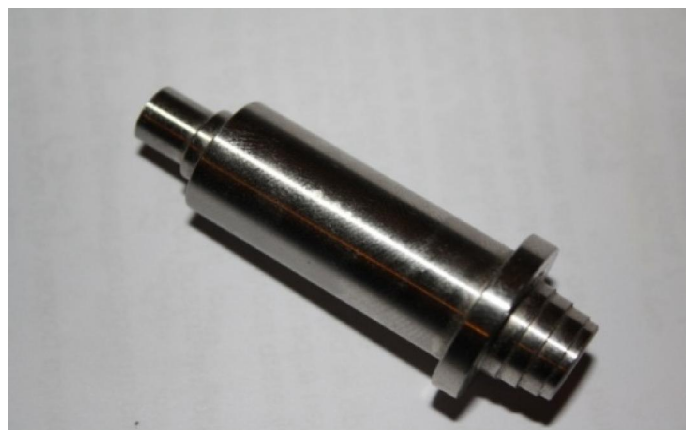
Slika 10: „Bravice“ rađene na CNC obradnom centru
