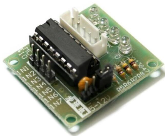
Slika 2.7. Upravljački sklop za unipolarne koračne motore ULN2003A [9]
