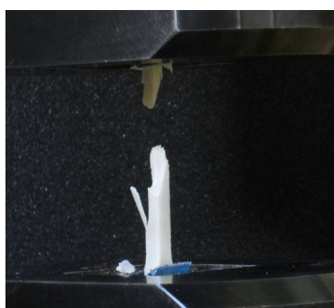
Slika 31. Lom epruvete prilikom tlačnog eksperimenta puzanja s naknadnim rasterećenjem
