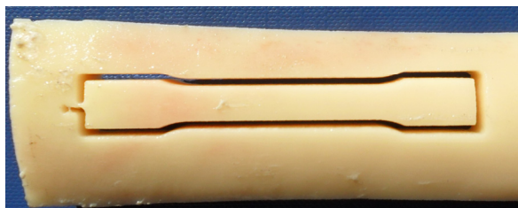
Slika 25. Longitudinalna epruveta izrezana vodenim mlazom iz goveđe kosti
