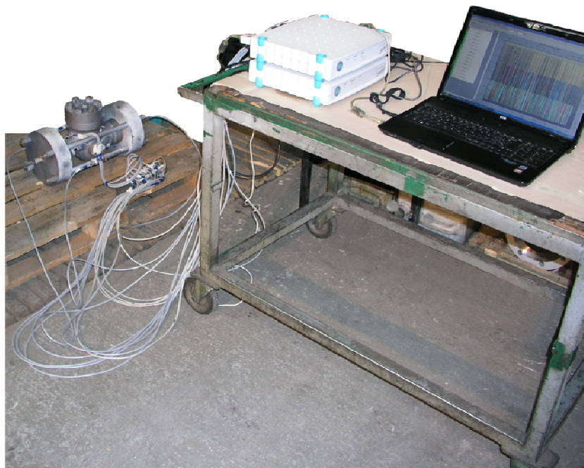
Slika 4.15 Ispitivanje deformiranja kućišta ventila
