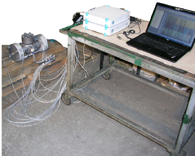
Slika 4.15 Ispitivanje deformiranja kućišta ventila
