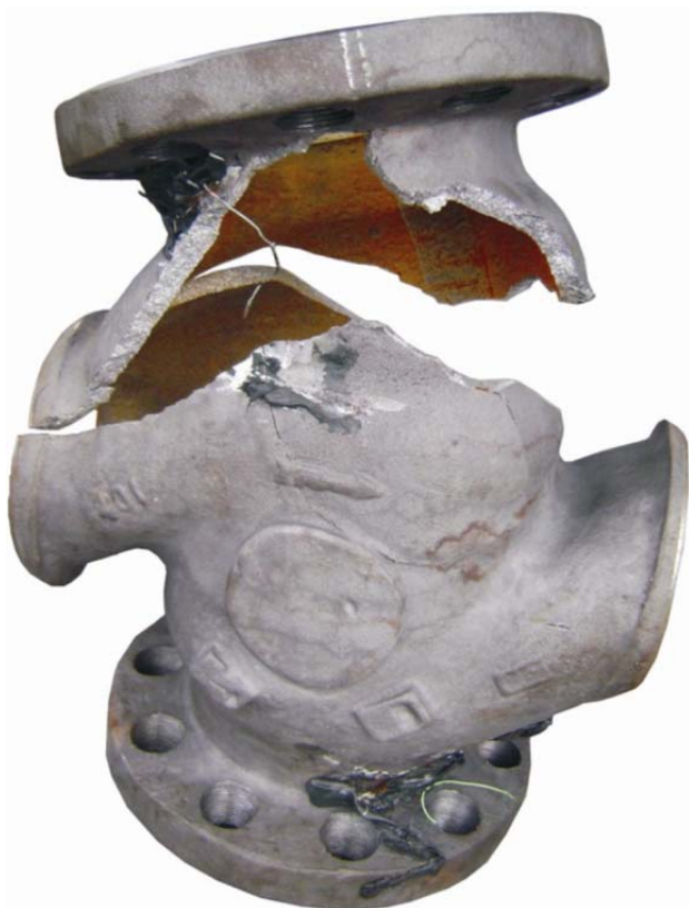
Slika 4.4 Prikaz slomljenog kućišta
