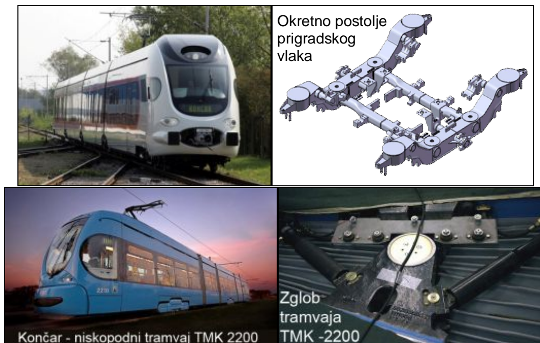
Slika 4. Niskopodni tramvaj i prigradski vlak s kritičnim komponentama
