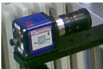
Slika 49. Kamera velikog povećanja ( high magnification camera ) tvrtke Messphysik
