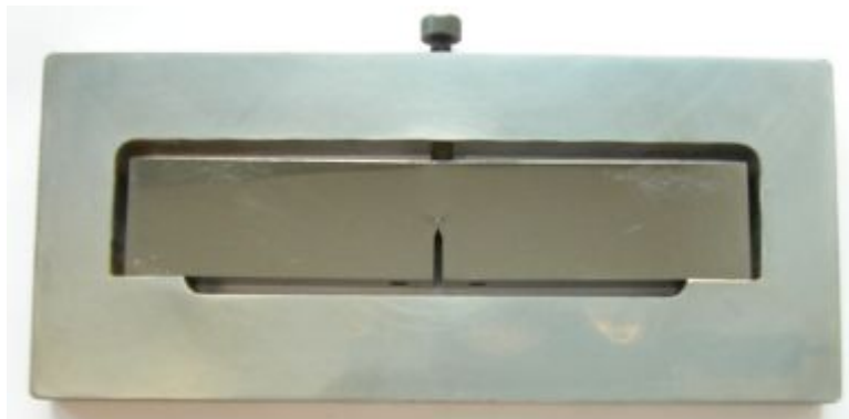
Slika 48. Naprava za opterećenje SENB epruveta
