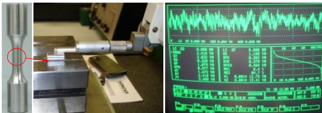
Slika 16. Mjerenje hrapavosti na Pertometru
