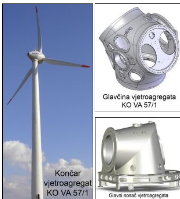
Slika 3. Vjetroagregat, snage 1MW i modeli ključnih komponenti tvrtke Končar
