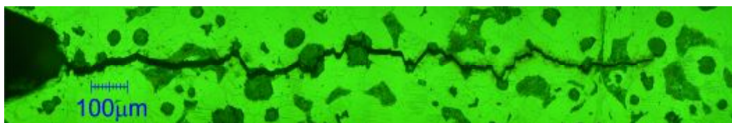
Slika 65. Pukotina u sekundarnoj mikrostrukturi ispitivanog nodularnog lijeva
