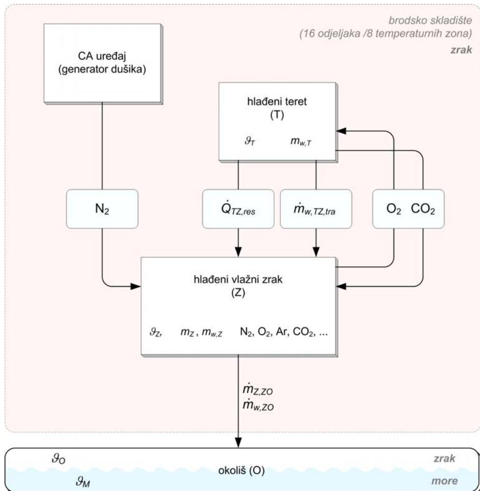
Sl. 5.1. Strukturalni model sustava metaboličnih procesa i nadzirane atmosfere
