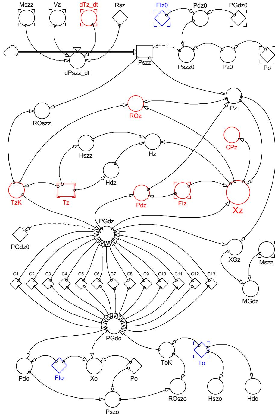
**SI. 6.2. Dijagram simulacijskog modela hlađenoga vlažnog zraka – 1. dio**
