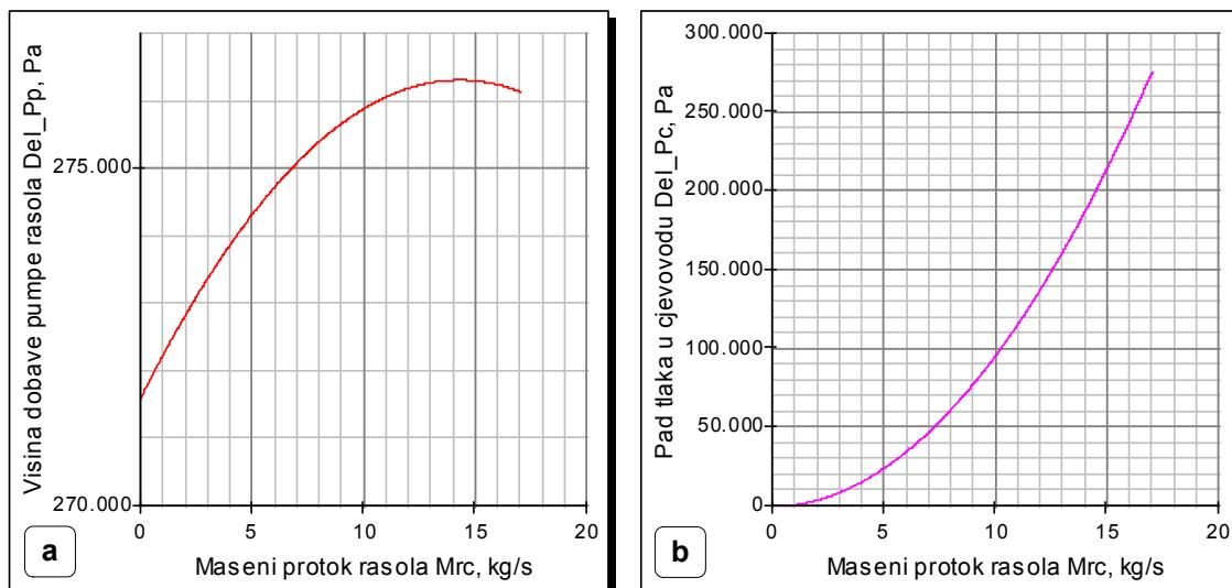
**SI. 6.33. Simulacijski rezultati radnih karakteristika pumpe rasola (a) i cjevovoda rasola (b)**
