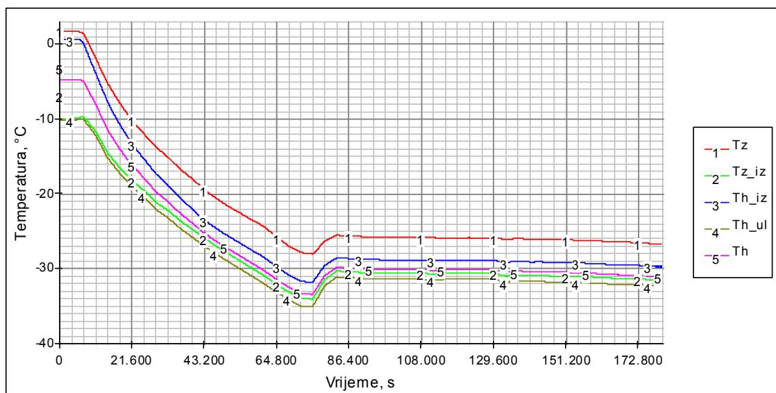
**Sl. 6.29. Rezultati simulacije temperatura zraka na ulazu ( $Tz$ ) i na izlazu ( $Tz_{iz}$ ) iz hladnjaka, temperatura rasola na ulazu ( $Th_{ul}$ ) i na izlazu ( $Th_{iz}$ ) iz hladnjaka i srednja temperatura površine hladnjaka zraka ( $Th$ )**
