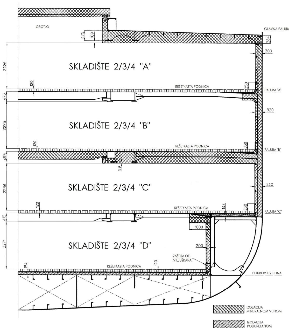
**Sl. 2.2. Presjek glavnim rebrom tipičnog konvencionalnog broda hladnjače ukupnog kapaciteta hlađenog prostora od 17.000 m<sup>3</sup> i površine 7.000 m<sup>2</sup>**
