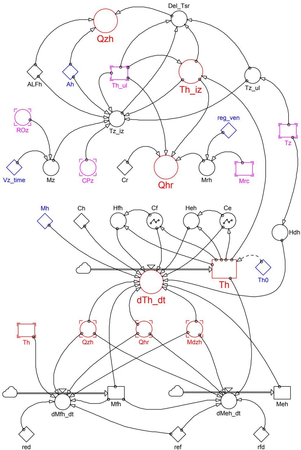
Sl. 6.8. Dijagram simulacijskog modela hladnjaka zraka – 1. dio
