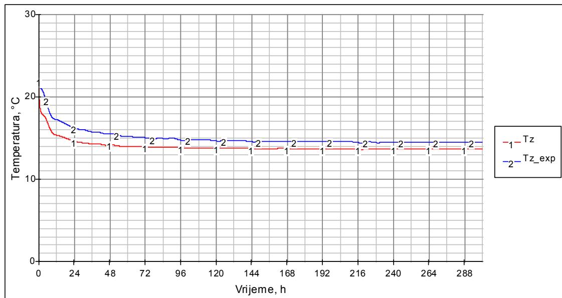
**Sl. 6.39. Usporedni rezultati simulacije (Tz) i mjerena (Tz\_exp) temperature hlađenoga vlažnog zraka u odjeljku 3A**
