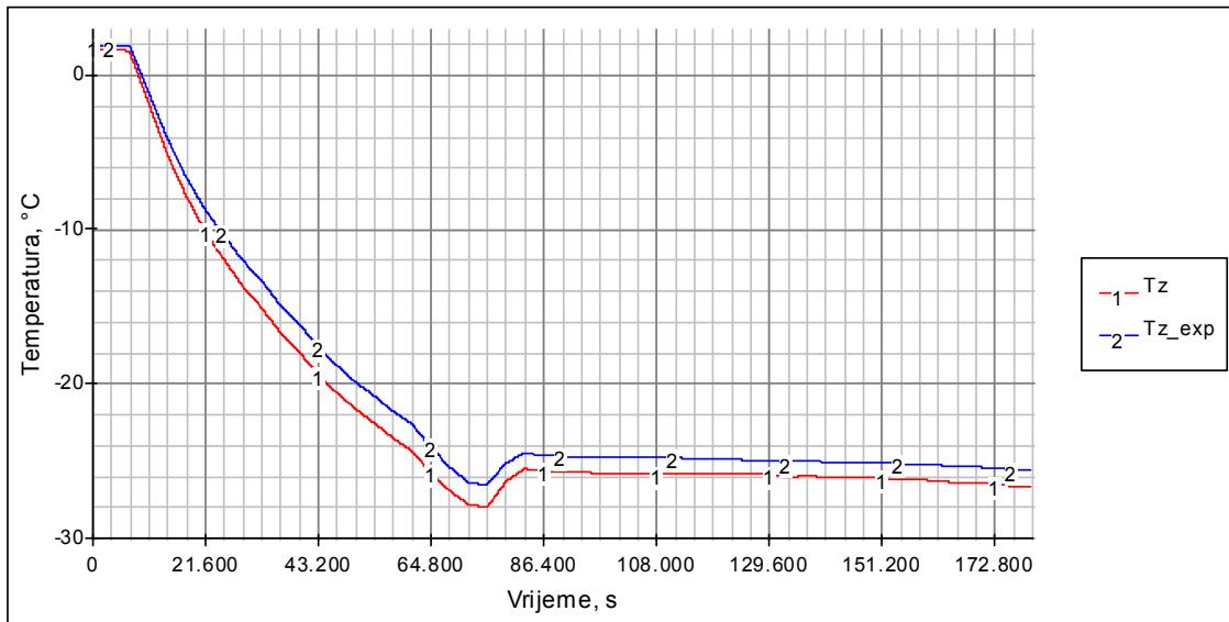
**Sl. 6.28. Usporedni rezultati simulacije ( $Tz$ ) i mjerena ( $Tz_{exp}$ ) temperature hlađenoga vlažnog zraka u odjeljku 3A**
