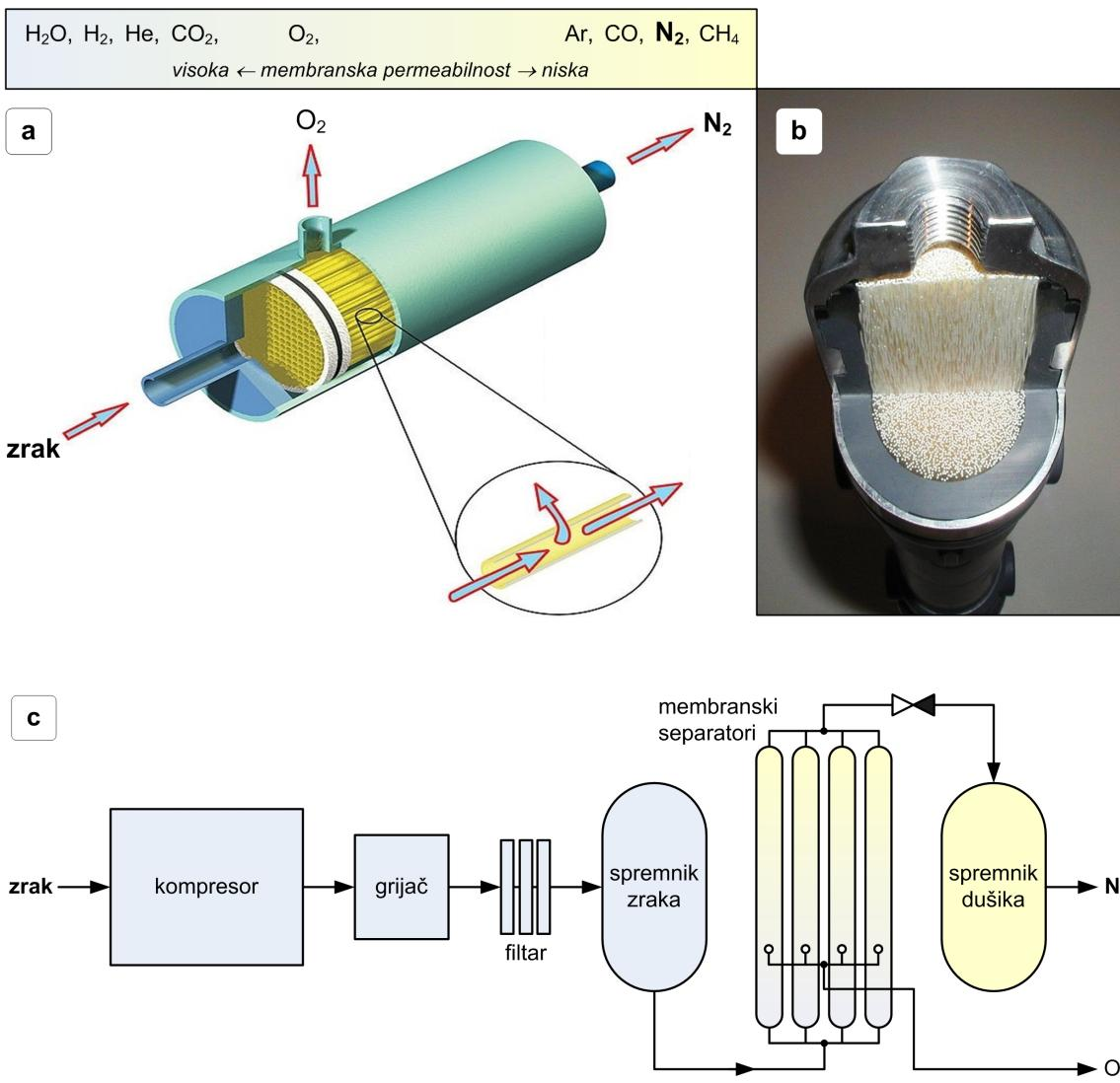
**Sl. 2.11. Membranski generator dušika: postupak dobivanja dušika (a), unutrašnjost membranskog separatora (b) i shema uređaja (c)**
