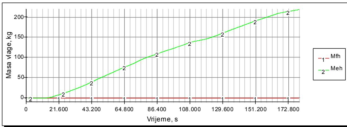
Sl. 6.30. Rezultati simulacije izlučene mase leda (Meh) i mase kapljevite vlage (Mfh) na površini hladnjaka zraka
