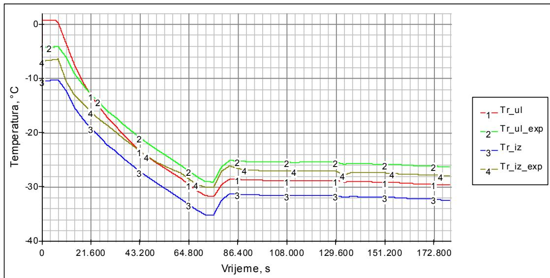
Sl. 6.31. Usporedni rezultati simulacije i mjerena temperatura rasola na ulazu (Tr
