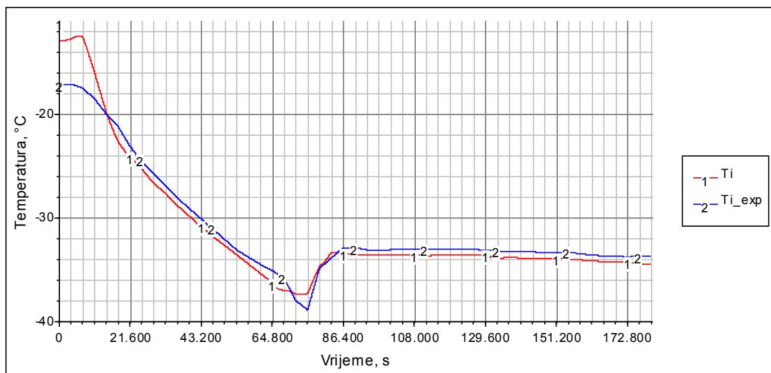
**SI. 6.32. Usporedni rezultati simulirane ( $T_i$ ) i izmjerene ( $T_{i\_exp}$ ) temperature isparivanja**
