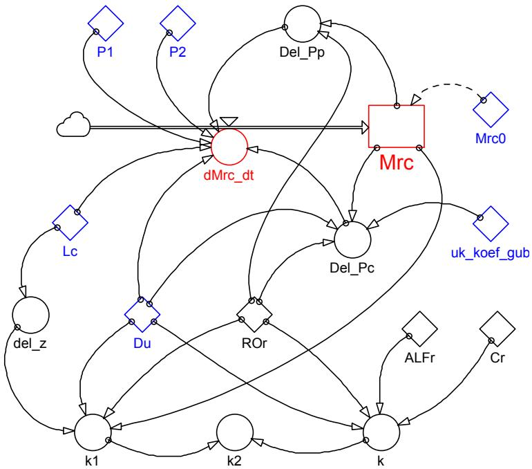
SI. 6.11. Dijagram simulacijskog modela sustava razvoda rasola – 1. dio
