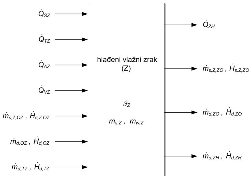
Sl. 4.5. Strukturalni model hlađenoga vlažnog zraka
