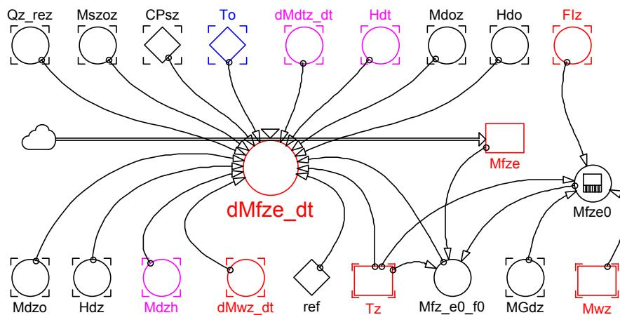
**SI. 6.4. Dijagram simulacijskog modela hlađenoga vlažnog zraka – 3. dio**
