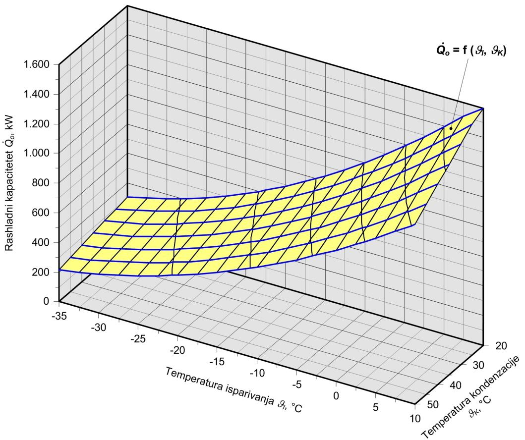
**Sl. 4.21. Rashladni kapacitet  $\dot{Q}_o$  rashladnika rasola Sabroe Marine AB VSB 81E ovisno o temperaturi isparivanja  $\vartheta_l$  i o temperaturi kondenzacije  $\vartheta_K$**
