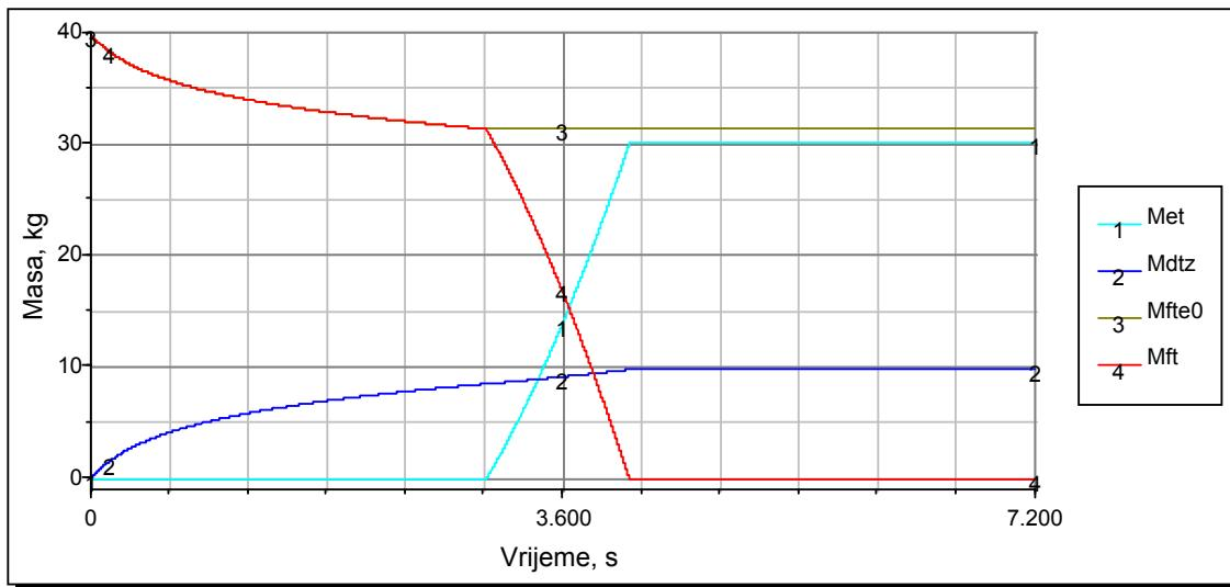
**SI. 6.22. Rezultati simulacije dinamike mase kapljevite vlage (Mft) i leda (Met) na površini tereta, te ishlapljene vlage (Mdtz) s površine tereta**
