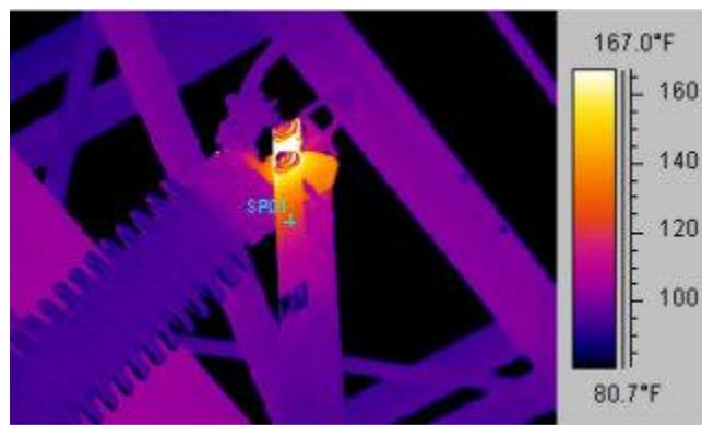
Slika 2. Termogram pregrijanog električnog spoja
