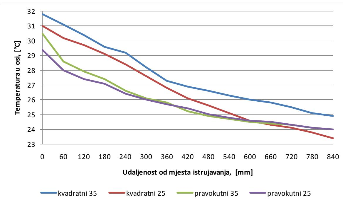
Slika 25. Termografski izmjerene vrijednosti temperatura za kvadratni i pravokutni istrujni otvor
