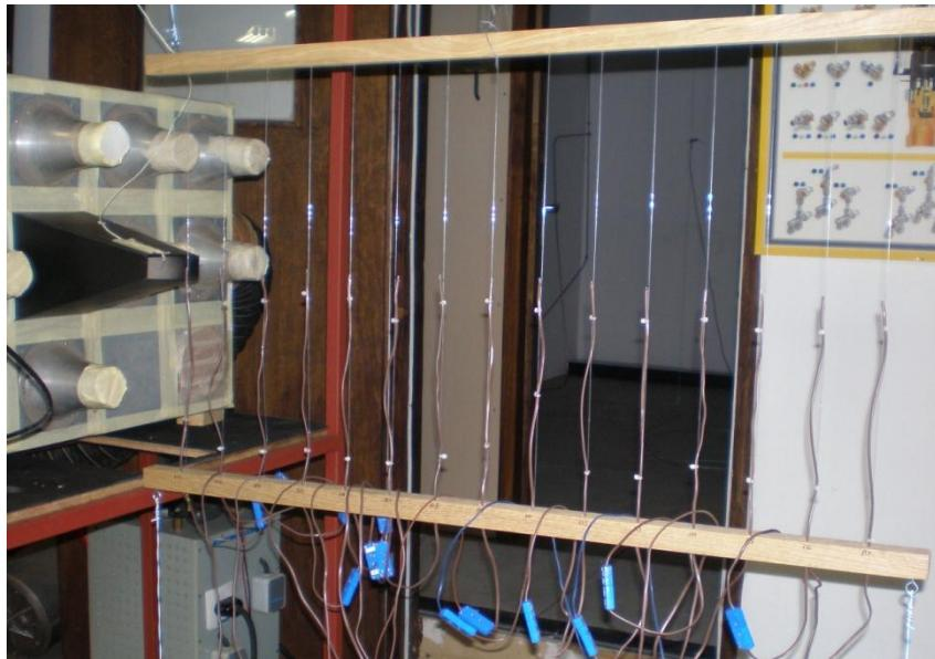
Slika 14. Termoparovi u struji zraka, pravokutni istrujni otvor
