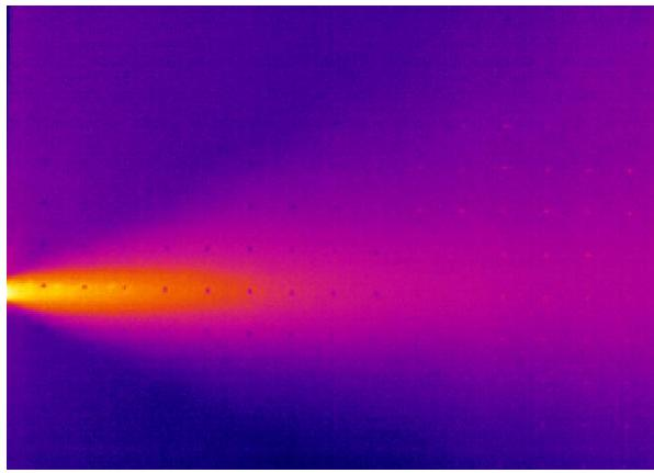
Slika 23. Pravokutni istrujni otvor, napon na motoru ventilatora 35 V
