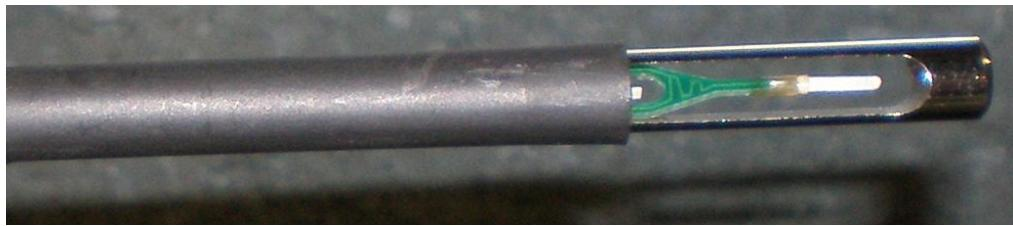
Slika 11. Anemometar sa žarnom niti
