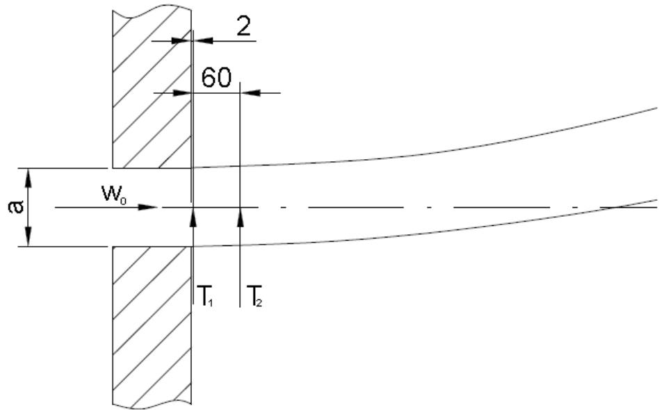
Slika 16. Udaljenosti mjernih točaka za pravokutni istrujni otvor
