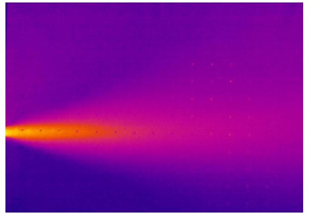
Slika 24. Pravokutni istrujni otvor, napon na motoru ventilatora 25 V
