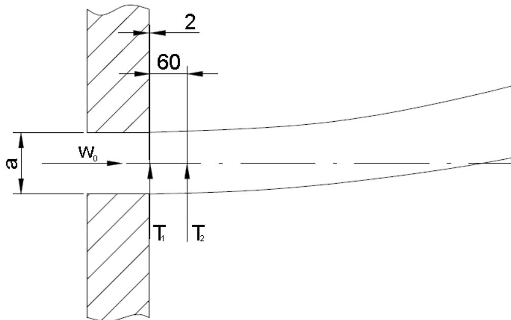
Slika 15. Udaljenosti mjernih točaka za kvadratni istrujni otvor
