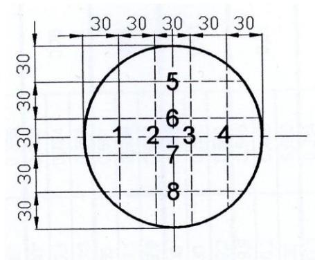
Slika 12. Pozicije mjerena brzina na usisnoj cijevi
