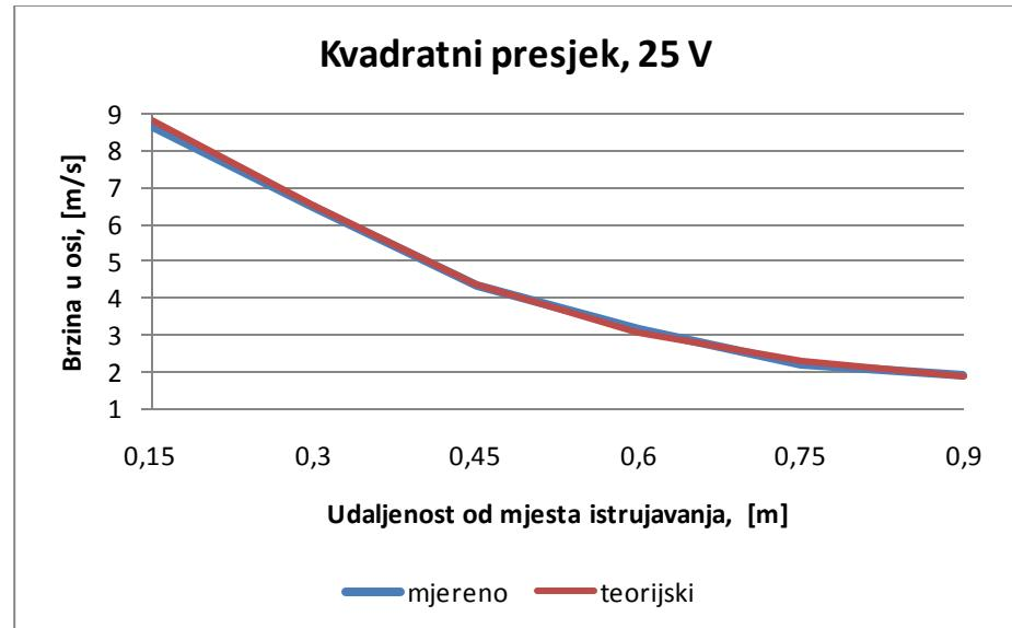
Slika 31b. Profil brzina za kvadratni presjek i napon 25 V
