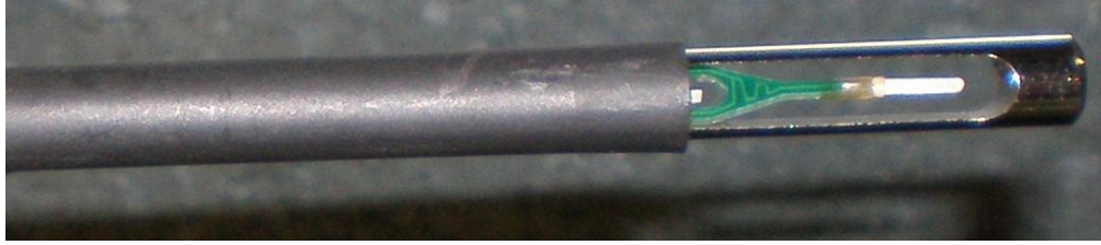
Slika 11. Anemometar sa žarnom niti
