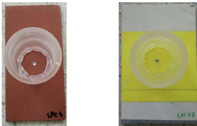
Slika 33. Prikaz oštećenja na uzorcima i zalijepljenih ćelija
