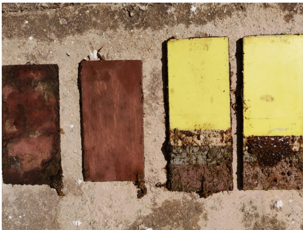
Slika 26. Stanje uzoraka nakon skidanja obraštaja
