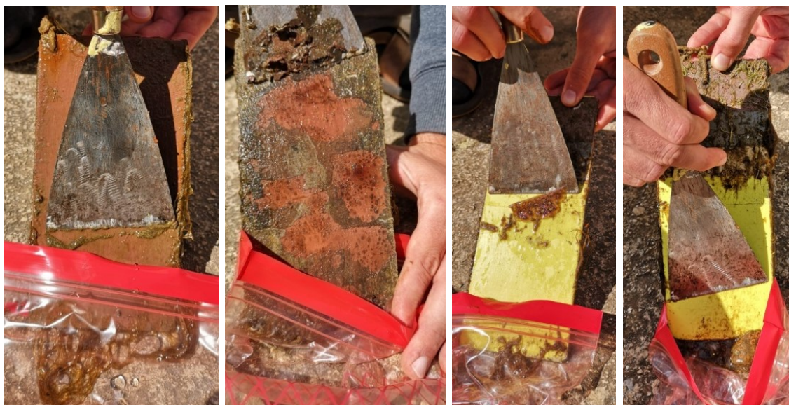
Slika 25. Skidanje obraštaja s uzoraka za terensko ispitivanje
