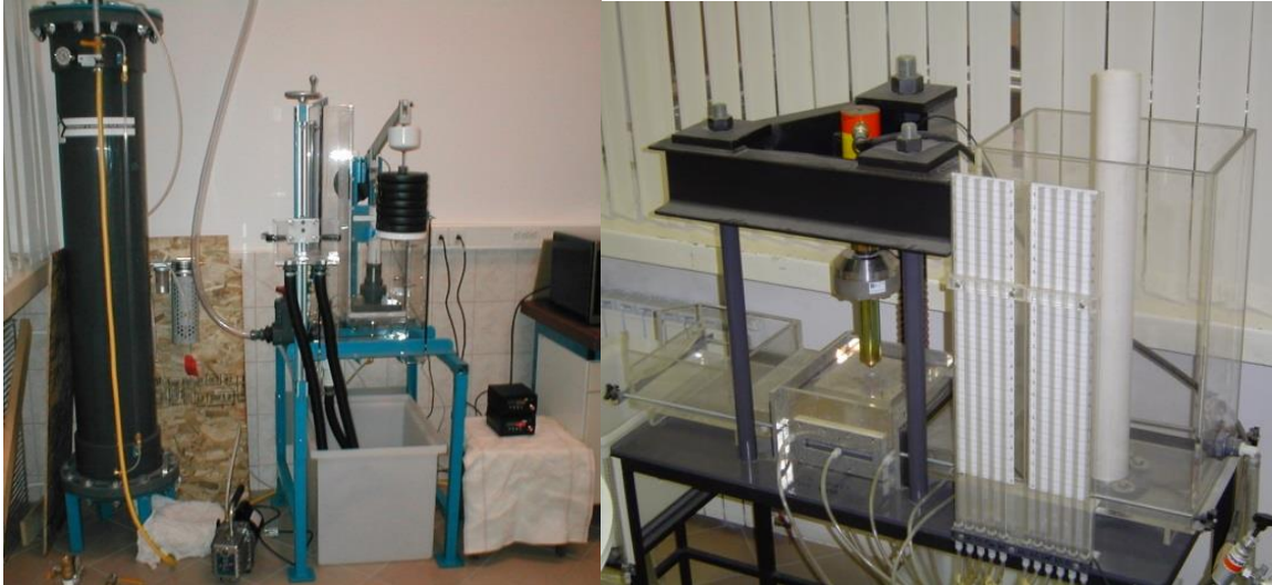
Slika 2. Uređaj za ispitivanje vodopropusnosti geotekstila u ravnini i okomito na ravninu uzorka
