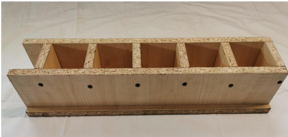
Slika 16. Kalup za probne uzorke
