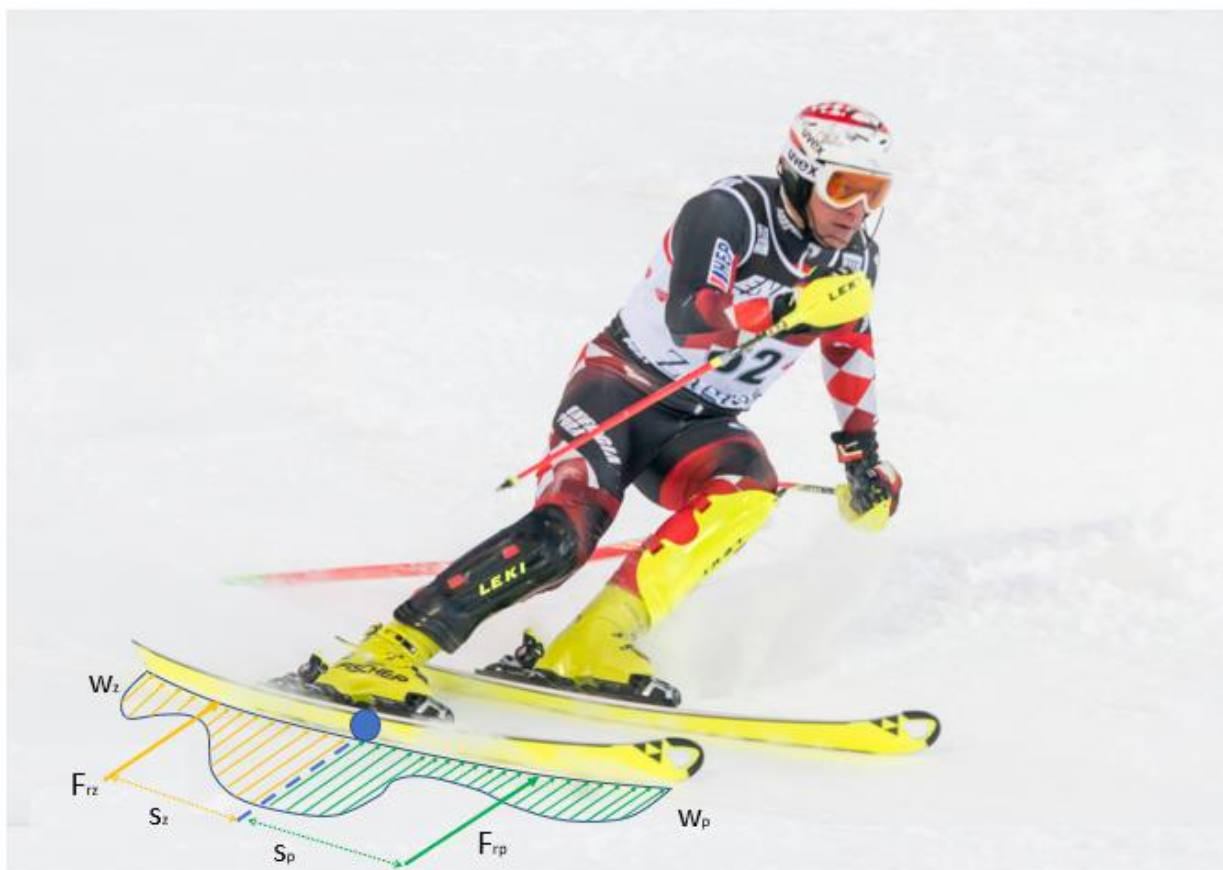
Slika 16. Raspodjela sile reakcije snijega na prednji i zadnji dio skije u skijaškom zavoju [10]
