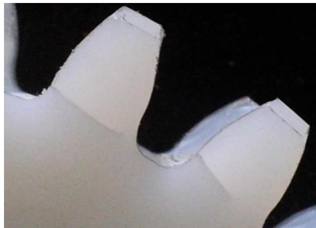
Slika 5.44 Pukotina na polimernom zupčaniku
