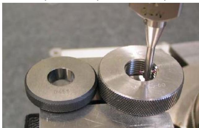
Slika 3-15 Mjerjenje navoja sa CMM-om s T-ticalom
