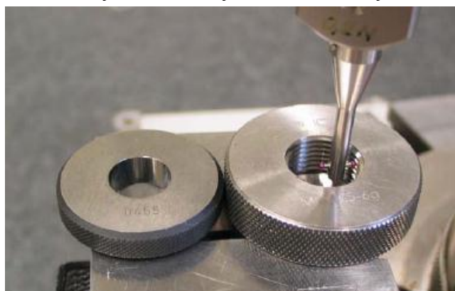
Slika 3-15 Mjerenje navoja sa CMM-om s T-ticalom
