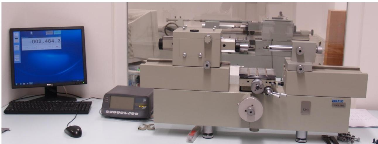
Slika 4-1 Univerzalni mjerni uređaj Joint DMS 680
