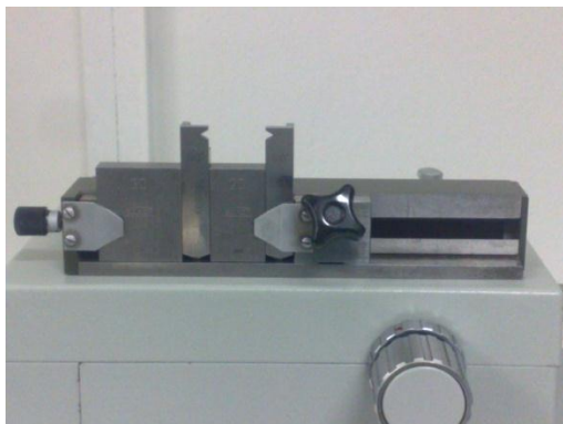
Slika 3-4 Stezna naprava za mjerke s V-utorom
