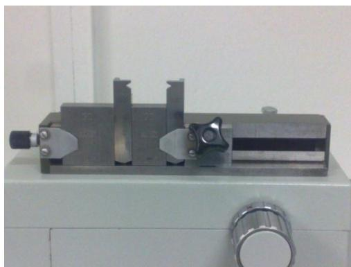
Slika 3-4 Stezna naprava za mjerke s V-utorom
