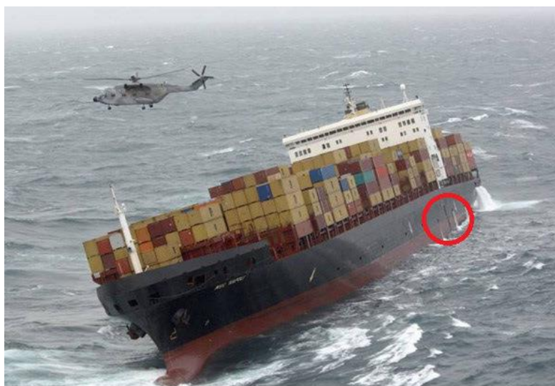
Slika 6.11 Fizičko oštećenje konstrukcije kontejnerskog broda MSC Napoli [48].
