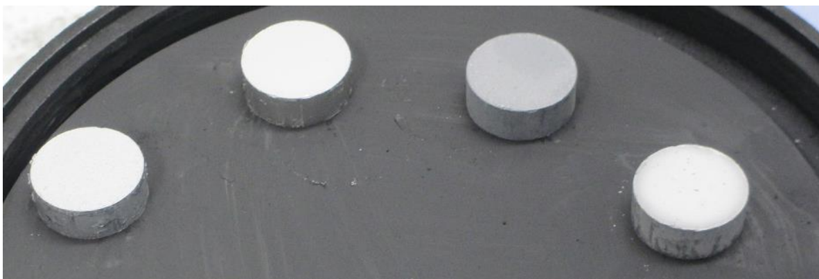
Slika 5.17. - Uzorci nakon izlaska iz sinter HIP- peći
