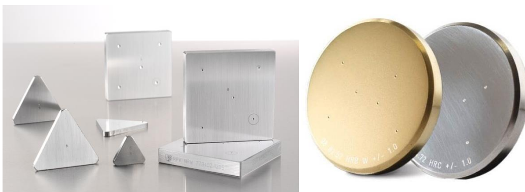
Slika 3.1. - Referentne pločice tvrdoće raznih oblika i materijala [22]
