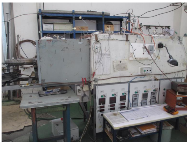
Slika 5.11. - Peć za sinteriranje u atmosferi vodika
