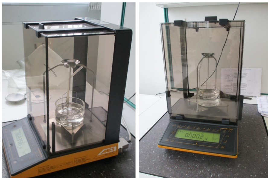
Slika 5.20. - Uređaj za mjerenje gustoće proizvođača Sartorius a) pločica smještena u gornju posudu b) uređaj za mjerenje gustoće
