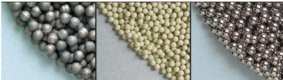
Slika 4.10. - Kuglice za mljevenje izrađene od različitih materijala [45]
