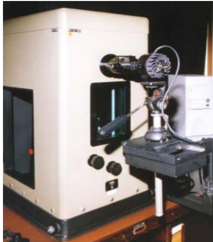
Slika 5.54. - Interferencijski mikroskop za provjeru ravnoće površine [5]
