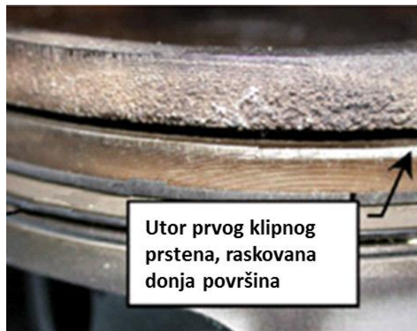
Slika 29. Erozivna oštećenja plamenog pojasa klipa i raskivanje utora prvog klipnog prstena [12]
