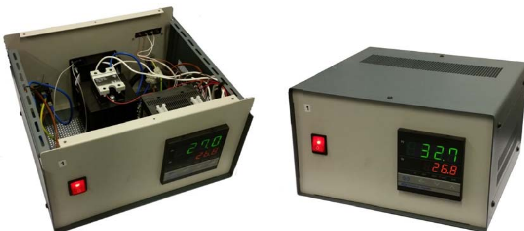
Slika 13. Regulator temperature grijača izlazne cijevi LRS-a.
