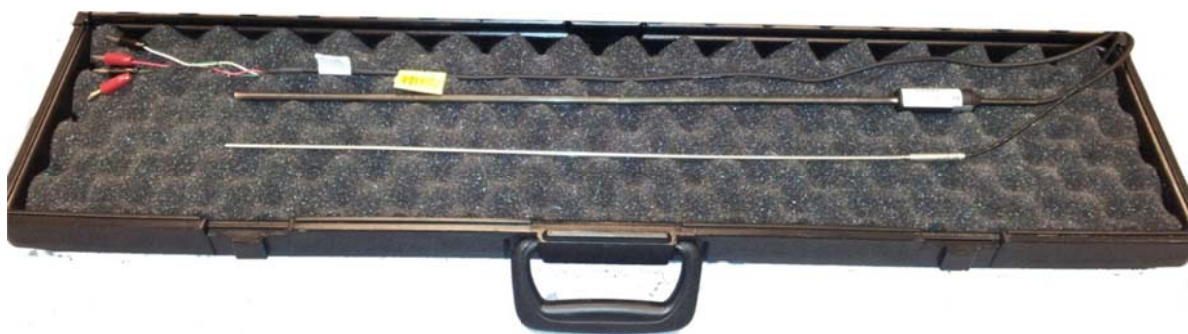
Slika 16. Termometri korišteni za mjerenje temperature kupke i komore saturatora.
