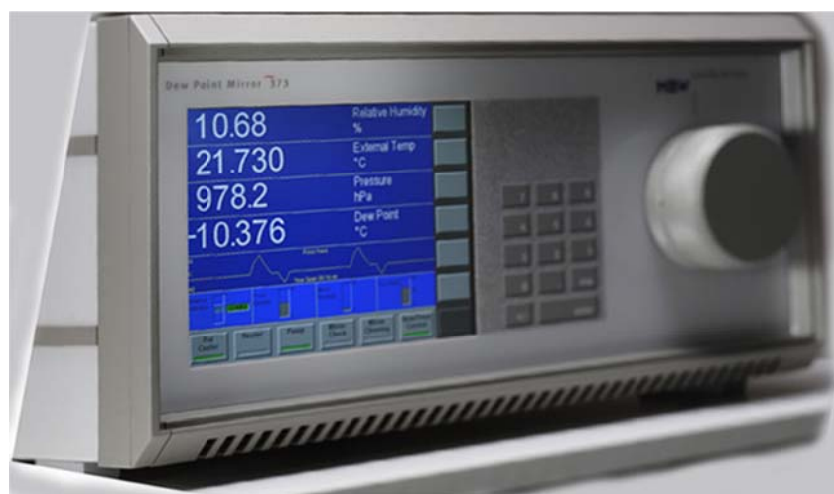
Slika 21. Higrometar točke rose MBW-373L, iz [51].
