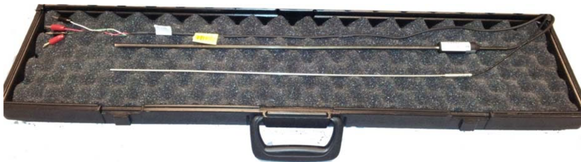
Slika 16. Termometri korišteni za mjerenje temperature kupke i komore saturatora.
