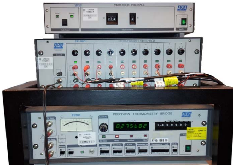
Slika 17. Termometrijski otporni most ASL F700 (TOM) s pripadnim skenerom.
