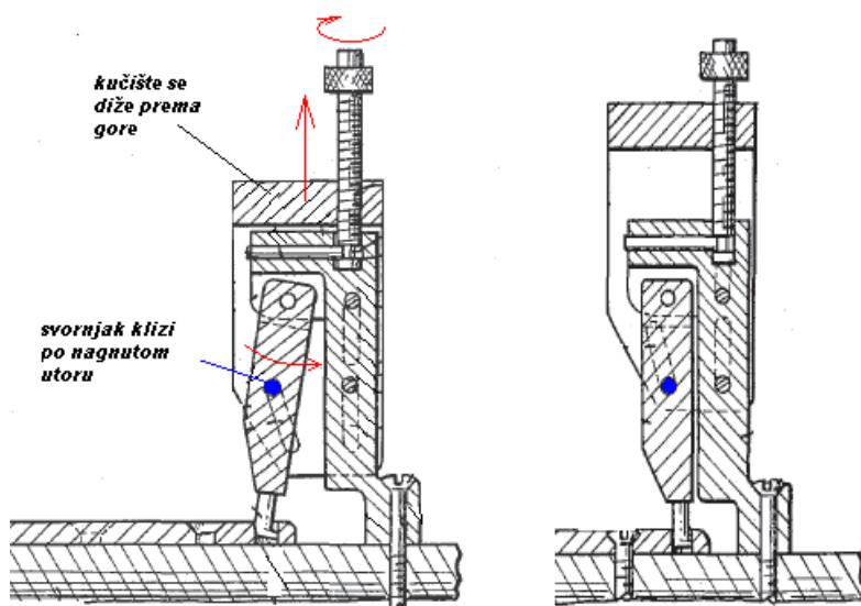
Slika 25. Princip rada i krajnji položaji priteznika [6]
