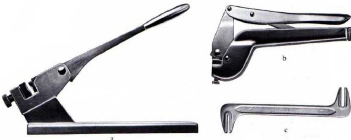
Slika 2. Uredaji za savijanje pločica za osteosintezu [1]
