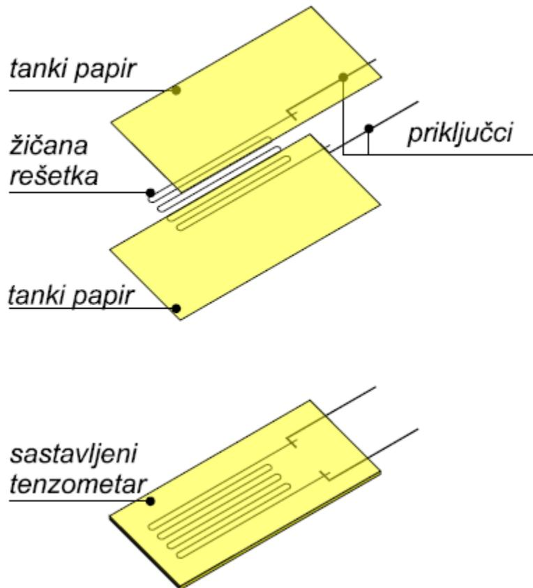
Slika 38. Tenzometar sa žičanom rešetkom [9]
