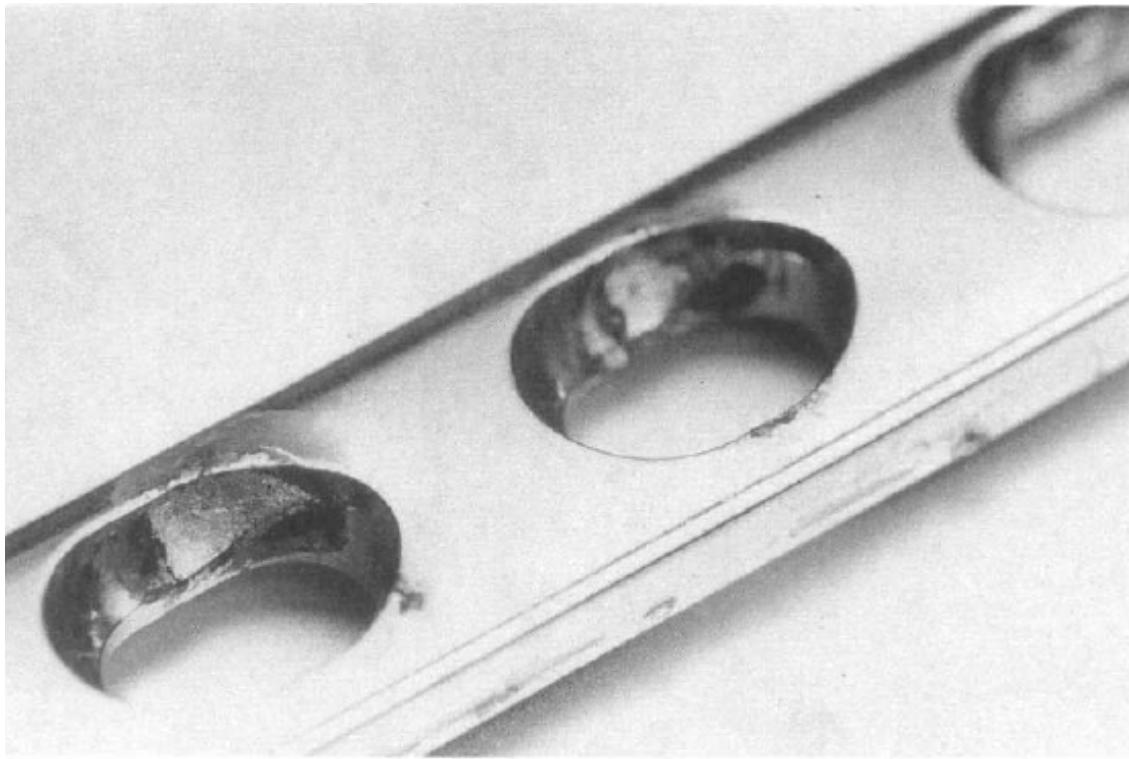
Slika 17. Pločica za osteositezu oštećena korozijom habanjem [2]
