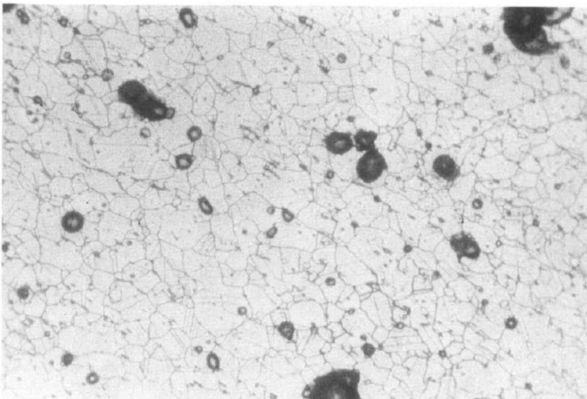
Slika 16. Površina nehrdajućeg čelika oštećena točkastom korozijom [2]
