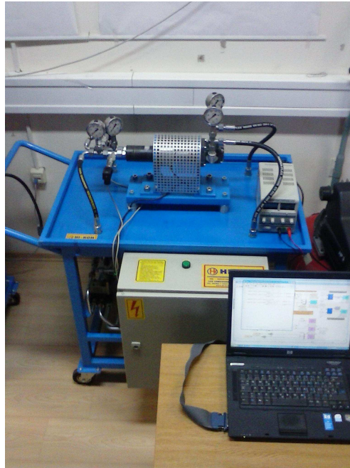
Slika 6.2: Fotografija eksperimentalnog postava rotacijskog elektrohidrauličkog servo sustava. (10) treba biti zatvoren, dok u drugom načinu treba biti otvoren.
