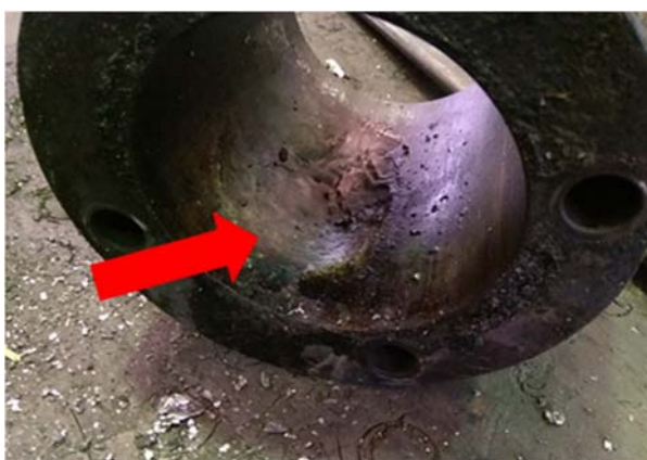
Slika 2.9 Erozijska uljavnog sustava kalupa za tlačni lijev
