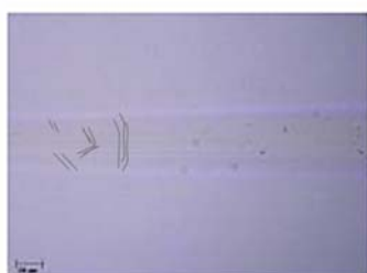
Pojava prvih pukotina L_{c1}
