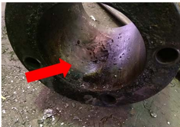
Slika 2.9 Erozijska uljavnog sustava kalupa za tlačni lijev
