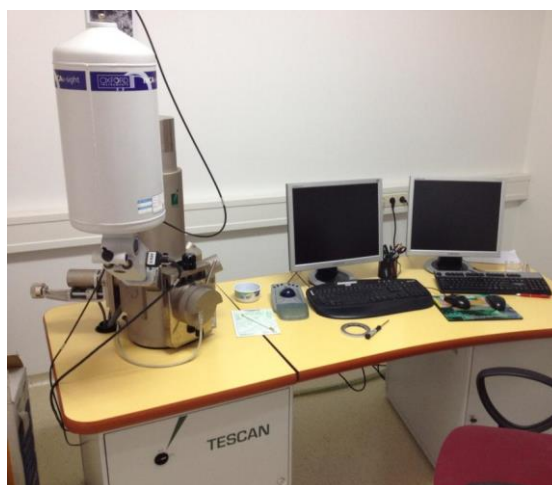
Slika 4.14 Skenirajući elektronski mikroskop korišten za analizu nemetalnih uključaka
