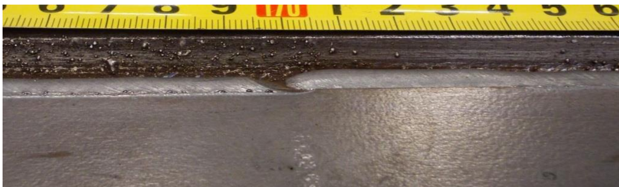
Slika 5.17 Količina kapljica u žlijebu zavara kao posljedica štrcanja kod konvencionalnog MAG zavarivanja – lijevo i CBT MAG zavarivanja – desno
