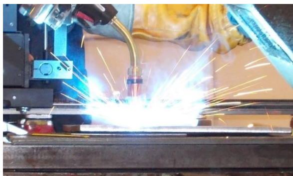
Slika 5.15 Konvencionalno MAG zavarivanje
