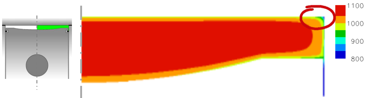
Slika 23. Temperaturna raspodjela unutar cilindra motora Cummins B – CFD simulacija [33]
