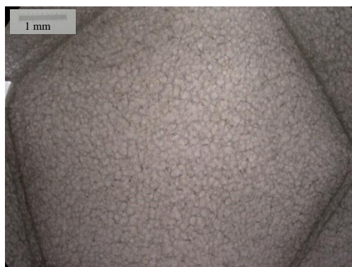
a) ekspanirani polistiren tlačne čvrstoće 50 kPa
