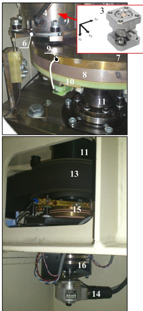
Slika 3-7: Rotacijska os tribometra
