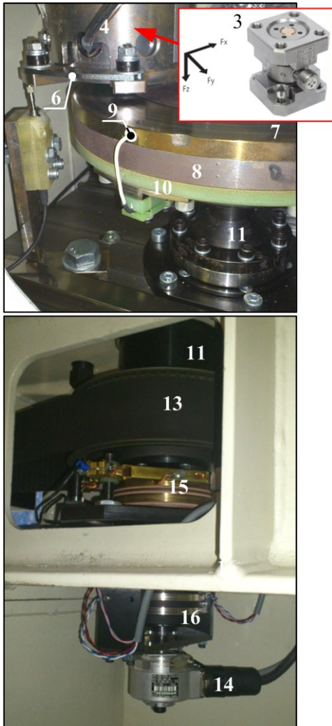
Slika 3-7: Rotacijska os tribometra
