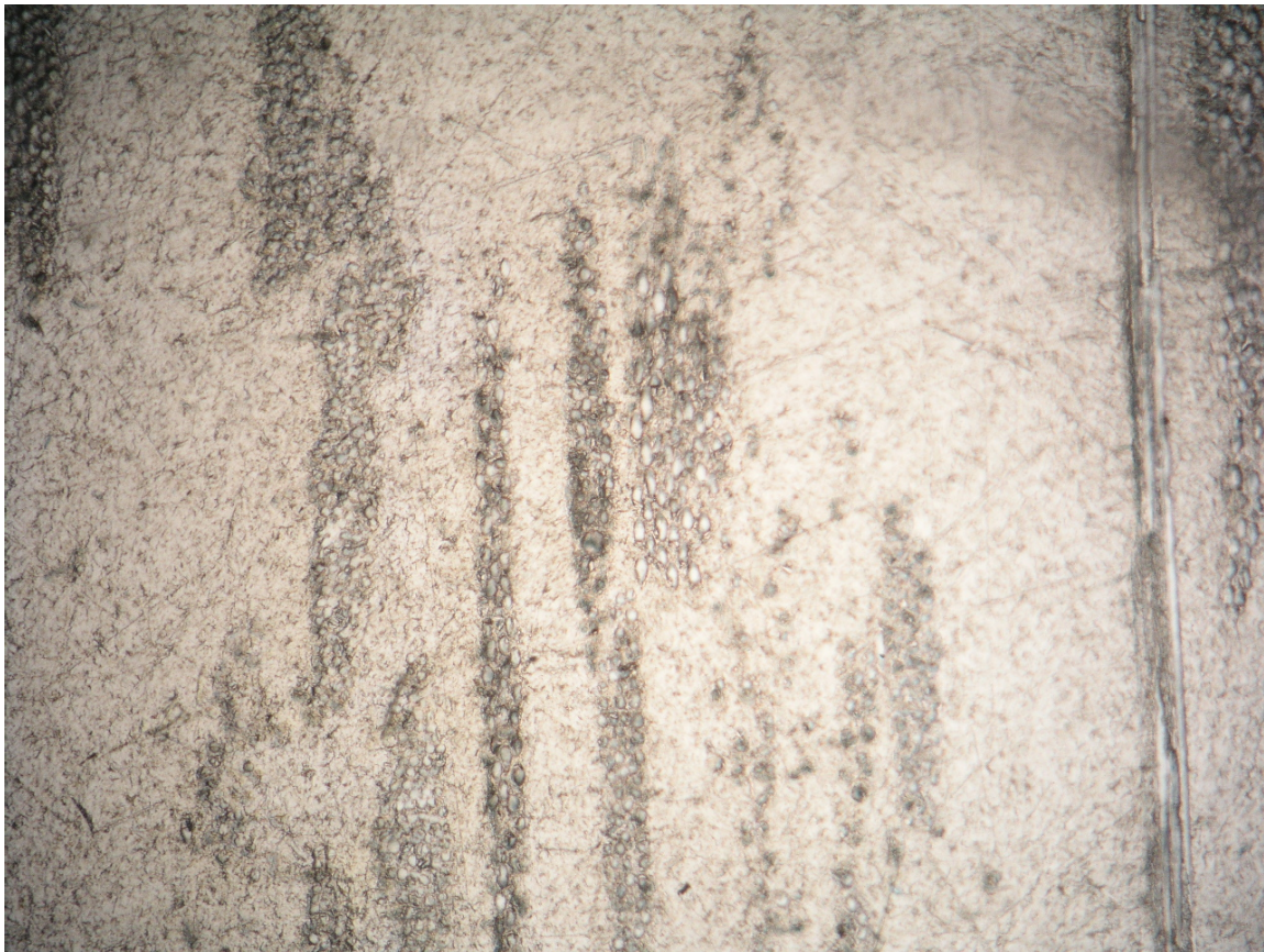
Slika 1. Mikrostruktura laminata od nezasićene poliesterske smole i staklenih vlakana, snimak 1
