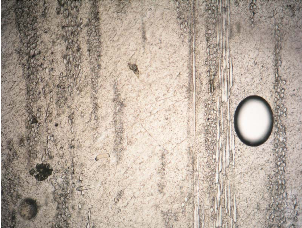
Slika 4. Mikrostruktura laminata od nezasićene poliesterske smole i staklenih vlakana, snimak 4
