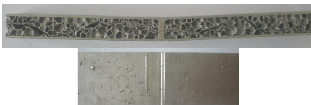
Slika 6.65. Prijelom epruvete A124
