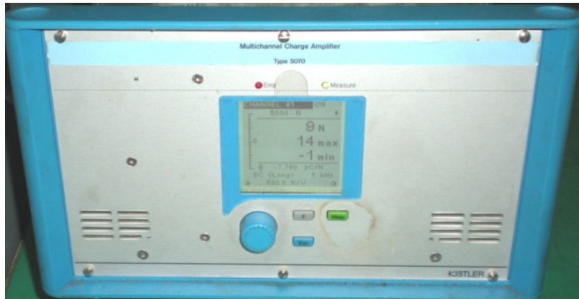
Slika 5.14. Višekanalno pojačalo KISTLER tip 5070A10000
