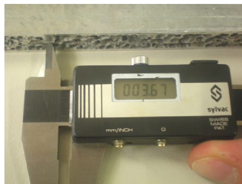
Slika 5.2. Mjerenje promjera pora digitalnim pomičnim mjerilom
