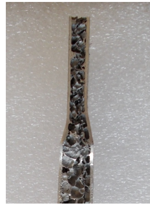
Slika 5.8. Epruveta za statičko vlačno ispitivanje deformirana u području postavljenom u stezne čeljusti kidalice
