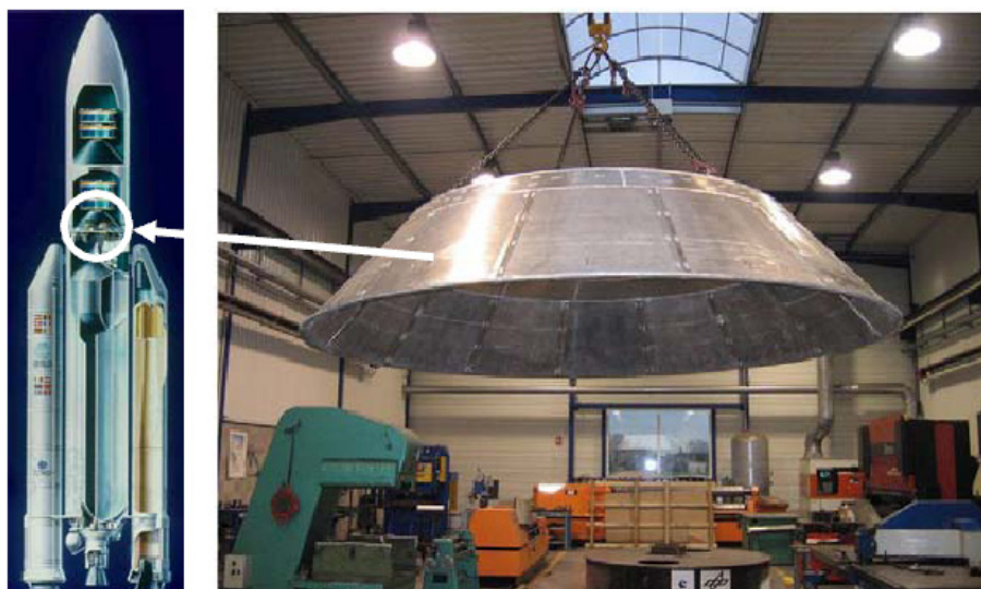
Slika 4.20. Prototip konusnog potpornja unutar tijela rakete „Ariane 5“ [27]
