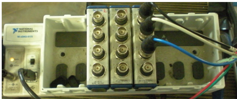
Slika 5.15. National Instruments kućište cDAQ-9172 s priključenim modulom 9215
