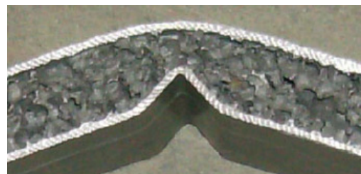
Slika 4.9. Deformacija uzorka nakon ispitivanja [105]
