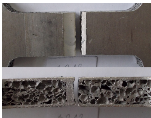
Slika 6.42. Prijelom epruvete B212
