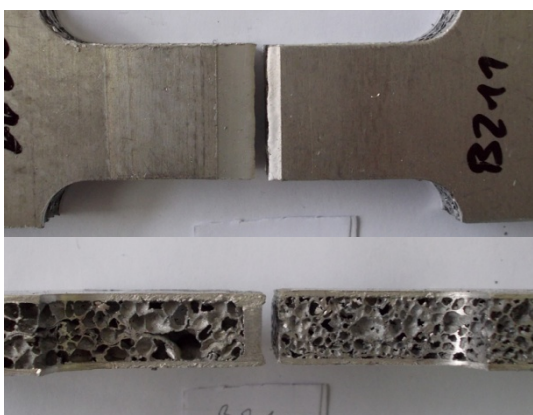
Slika 6.41. Prijelom epruvete B211
