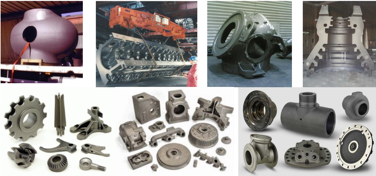
Slika 2.2 Primjeri odljevaka od nodularnog lijeva [30]
