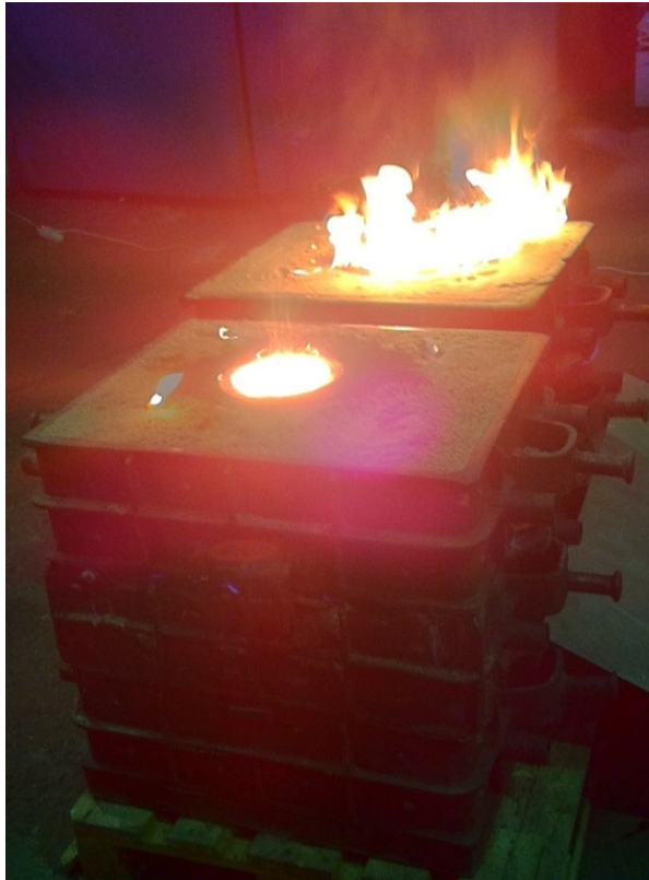
Slika 3.13 Kalupi 5 i 6 neposredno nakon ulijevanja
