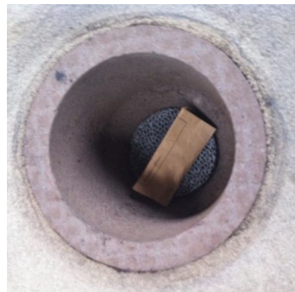
Slika 3.10 Dodavanje bizmuta na filter
