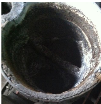
Slika 3.7 Cijepljenje u lonac, a) cjepivo u Sandwich loncu, b) prelijevanje taljevine preko cjevica
