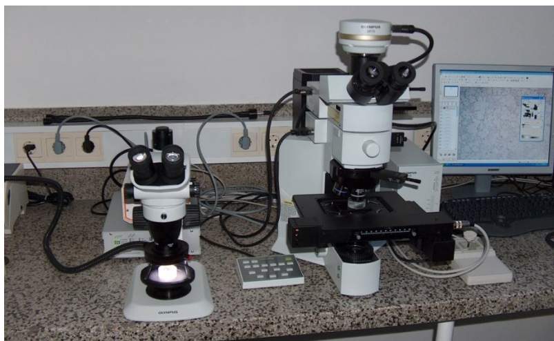
Slika 3.21 Sustav za metalografsku analizu
