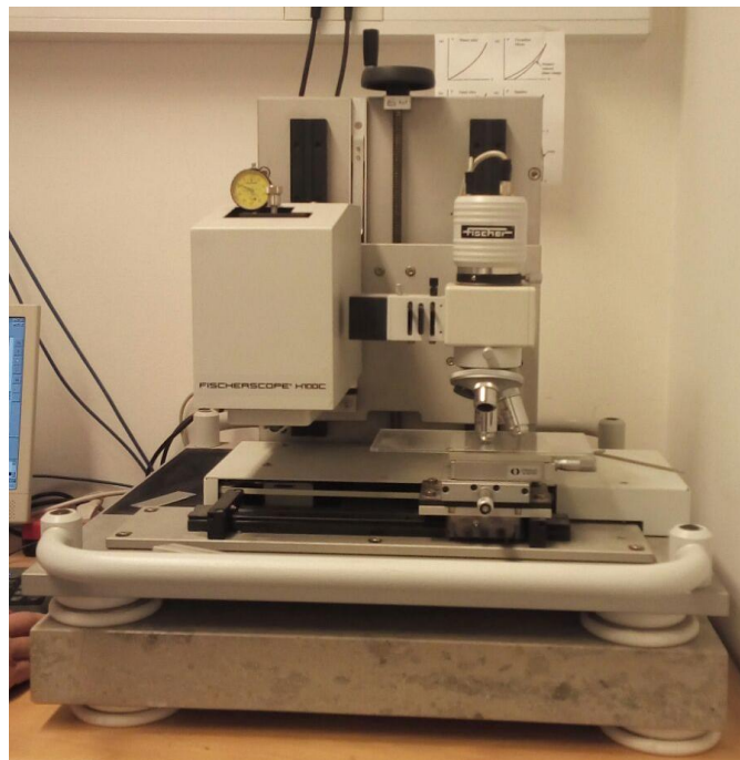
Slika 5.20 Uređaj za nanoindentaciju Fischerscope H100C
