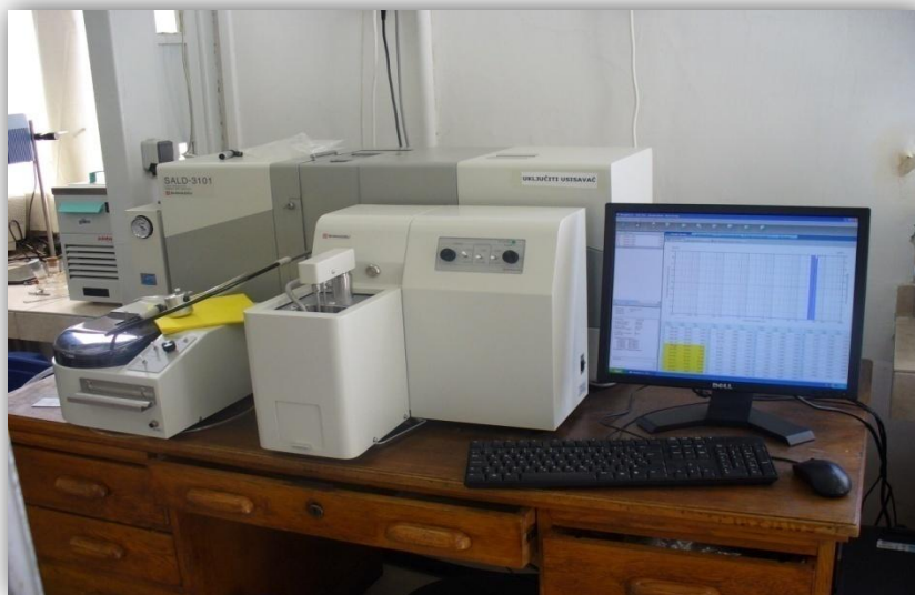
Slika 5.4 Uređaj za određivanje raspodjele veličina čestica metodom laserske difrakcije Shimadzu SALD-3101 [116]
