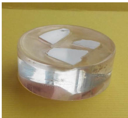
Slika 5.15 Zaliveni uzorci za keramografsku pripremu
