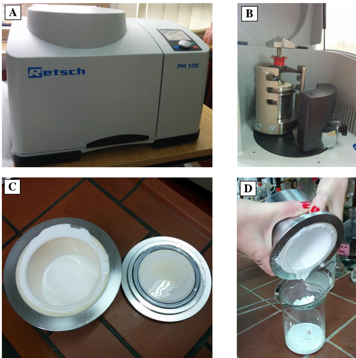
Slika 5.5 Priprava keramičkih suspenzija: (A) planetarni kuglični mlin Retsch PM 100; (B) pozicioniranje posude za miješanje u planetarnom kugličnom mlinu; (C) otvorena posuda mlina nakon provedene homogenizacije; (D) filtracija suspenzije (odvajanje keramičkih kuglica).
