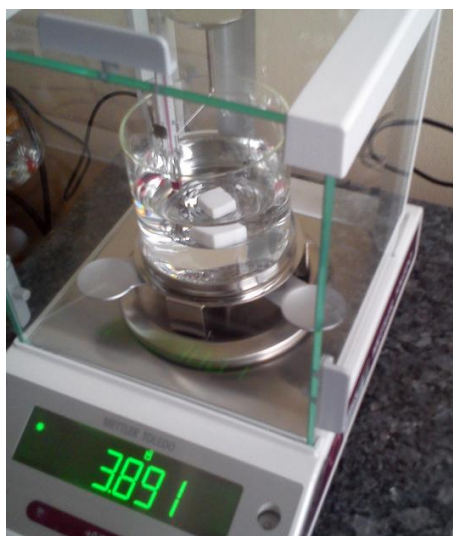
Slika 5.14 Određivanje Arhimedove gustoće [99]
