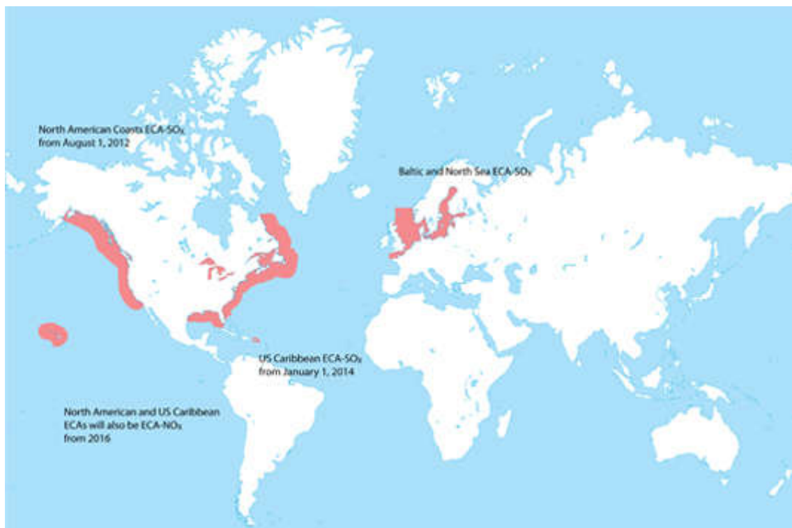
Slika 10 Područja kontrolirane emisije štetnih spojeva (ECA) [14]
