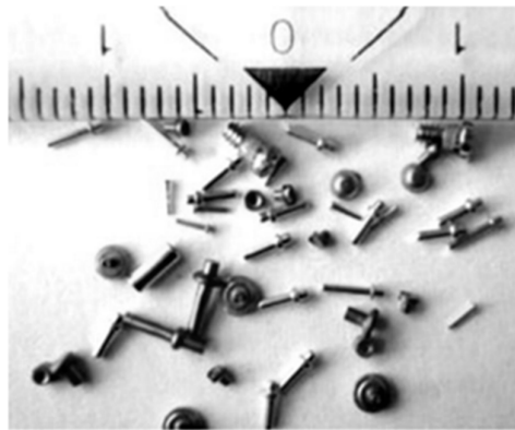
Slika 30: Mikro proizvodi dobiveni postupkom volumenskog oblikovanja [73].
